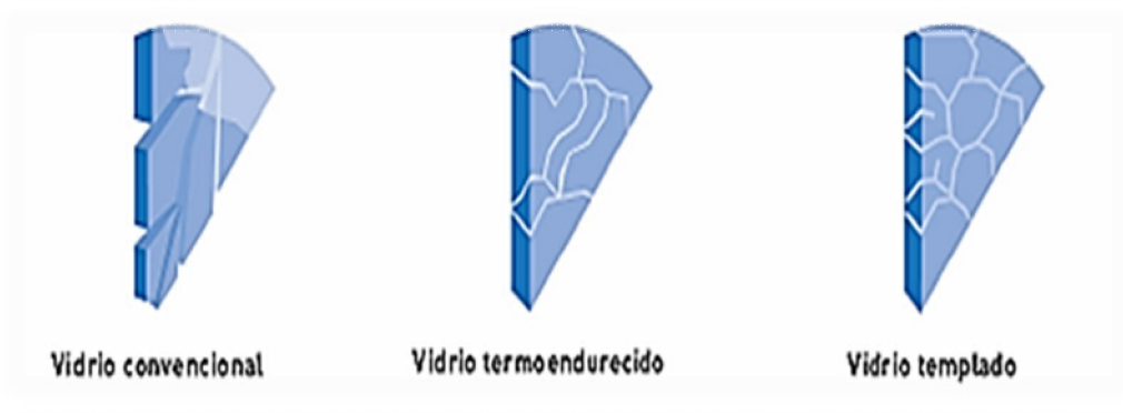
Gráfico # 16.- Comportamiento del vidrio bajo rotura (termoendurecido vs. templado).
