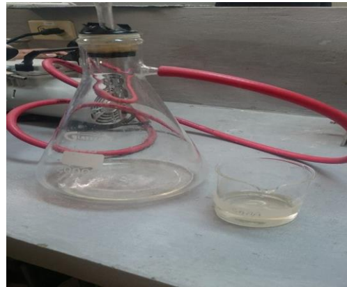
Filtración al vacío
