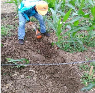
Fig. 16. Realización de calicatas
