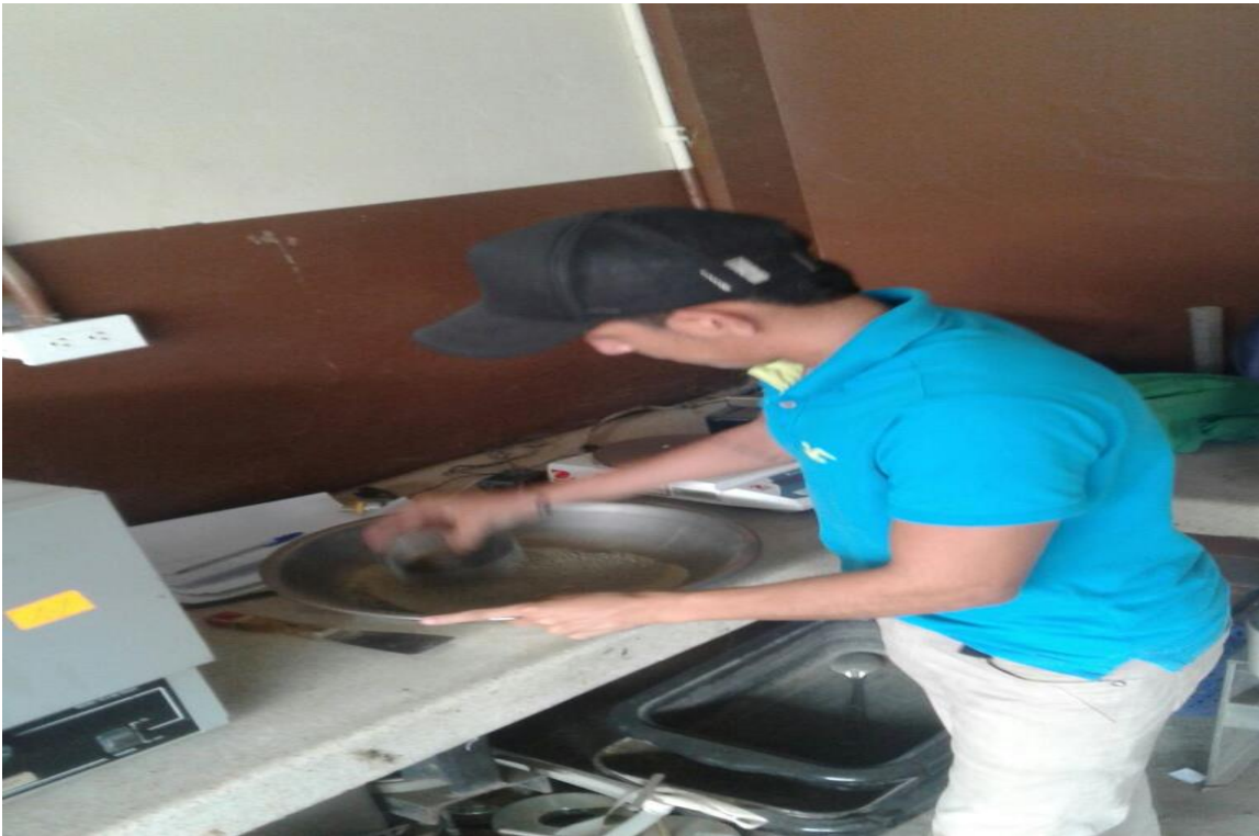
Trituramiento de material para límite plástico y límite líquido
