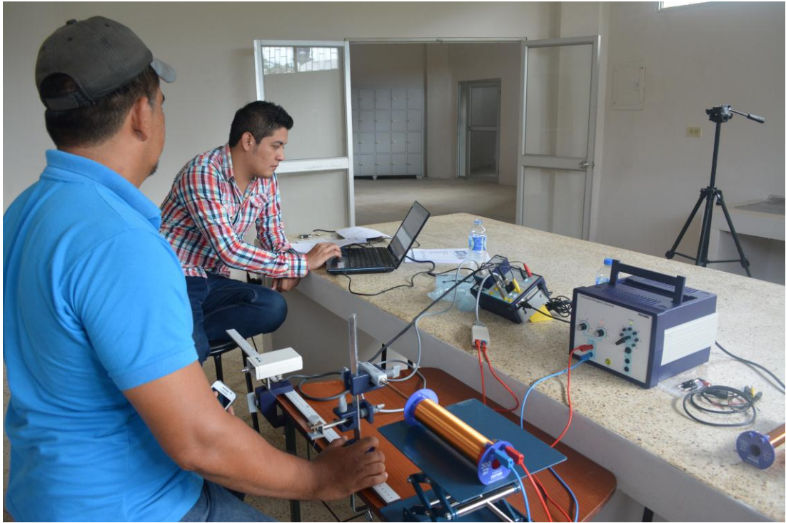
Practica de campo magnético de las bobinas individuales / ley de Biot-Savart
