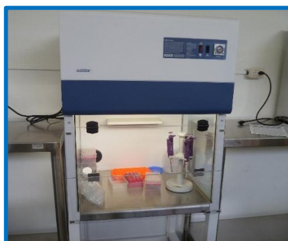
Cabina de flujo laminar para PCR (ESCO SRC-2A2).
