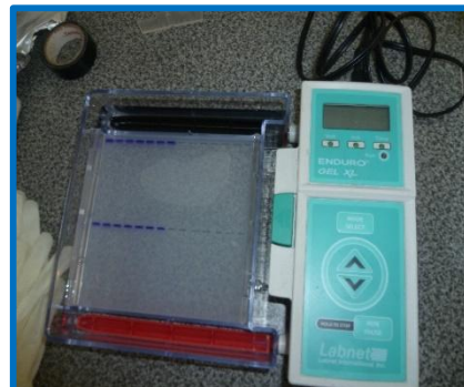
Cámara de electroforesis (LABNET -E0160).
