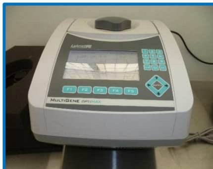
Termociclador (LABNET - MULTIGENE OPTIMAX).
