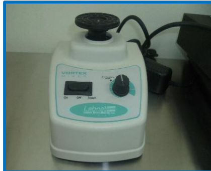
Agitador Vortex (LABNET S-0200).
