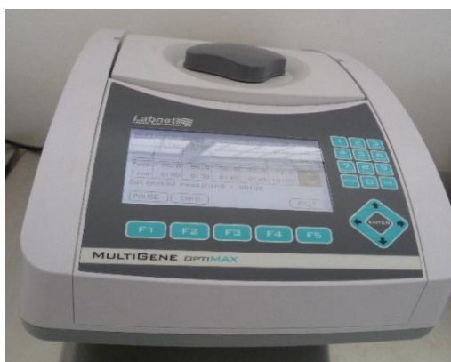
Fot. 11. Termociclador, máquina que calienta y enfría la reacción en temperaturas precisas para que se den las reacciones de PCR.
