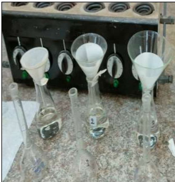
Fig. 8. Imagen donde las muestras pasan por un papel filtro #42 para evitar cualquier paso de cuerpos extraños
