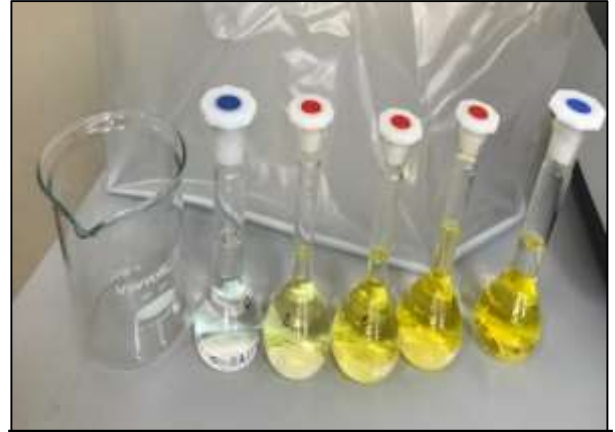
Fig. 11. Muestras elaboradas, con su debido reposo de aprox. 10min para ser analizadas en el espectrofotómetro
