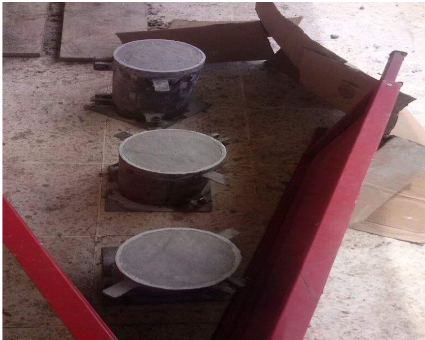
MUESTRAS PARA ENSAYOS DE RESISTENCIA DE HORMIGON
