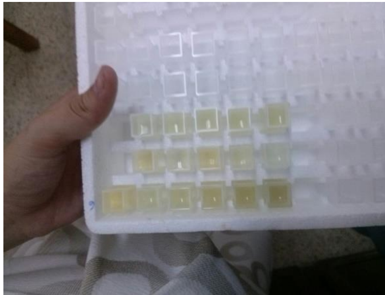
Anexo 1.12. Preparación de las muestras para tomar lectura en el espectrofotómetro
