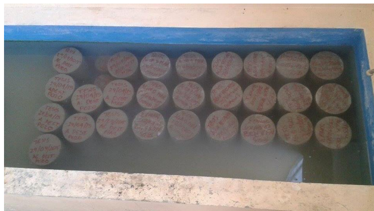
Contenido: Muestras de hormigón en piscina.
