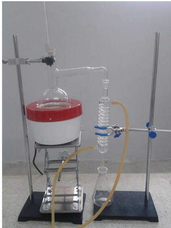
Contenido: Proceso de destilación del agua del Río Portoviejo
