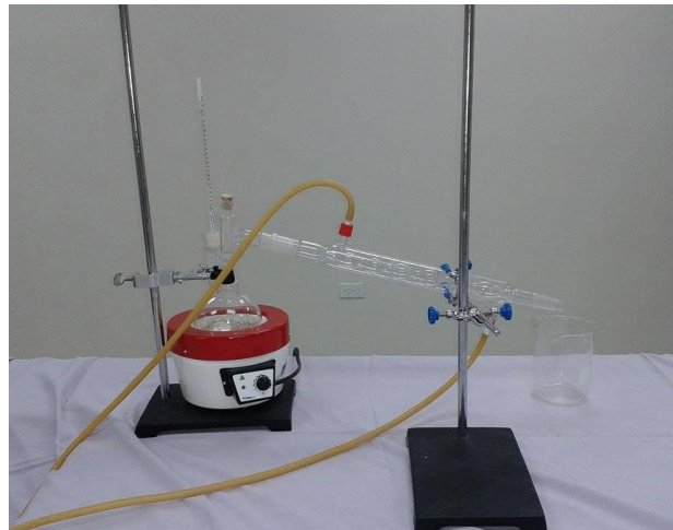
Contenido: Destilador con refrigerante de rosario
