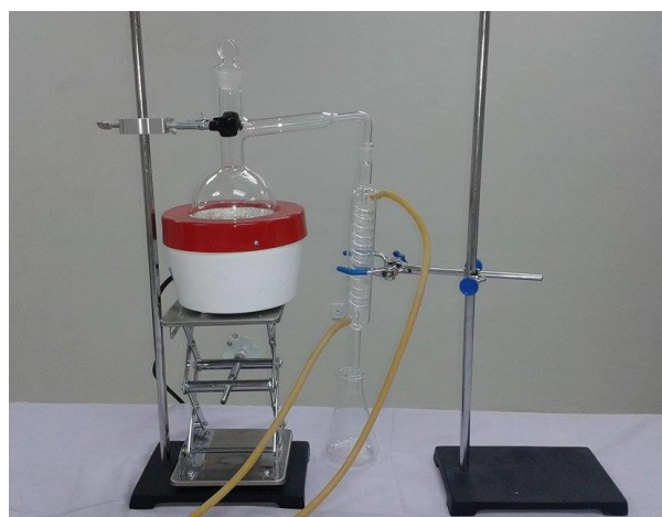
Contenido: Destilador con refrigerante de serpiente
