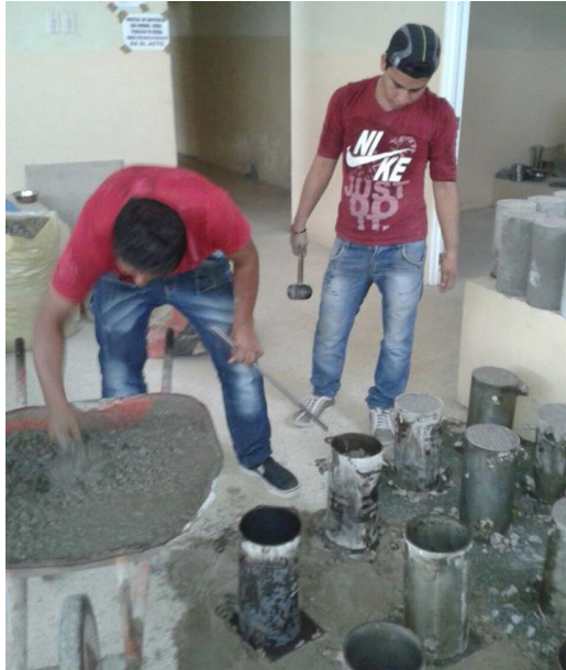
Contenido: Vaciado del hormigón en los moldes
