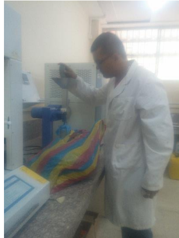
Molienda de las muestras de Pasto Saboya ( Panicum maximum ) y Panca de Maíz ( Zea mays ), en el Molino IKA MF 10 basic
