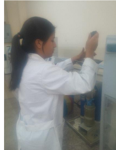
Molienda de las muestras de Pasto Saboya ( Panicum maximum ) y Panca de Maíz ( Zea mays ), en el Molino IKA MF 10 basic
