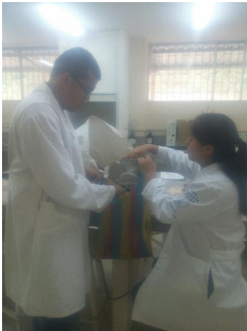
Molienda de las muestras de Pasto Saboya ( Panicum maximum ) y Panca de Maíz ( Zea mays ), en el Molino IKA MF 10 basic
