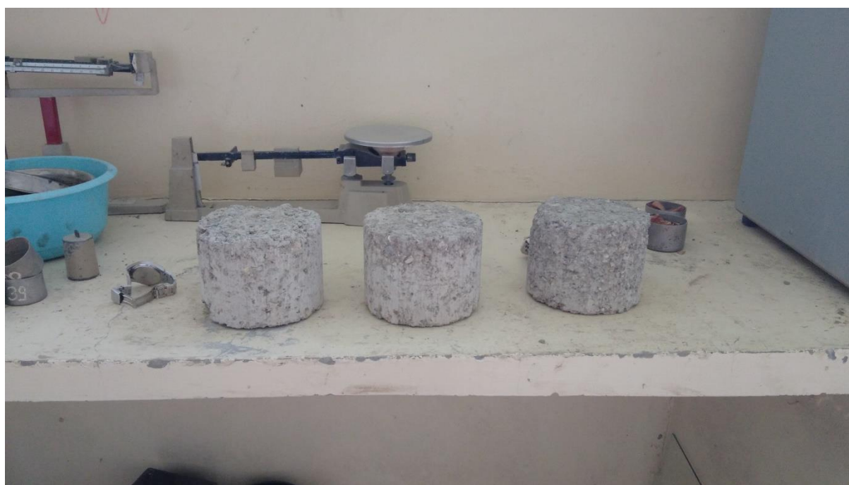
Imagen 18 Muestras para realizar la determinación del desgaste
