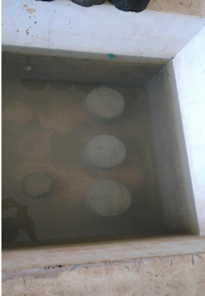
Imagen 16 Muestra sumergida en el agua para el ensayo de humedecimiento-secado
