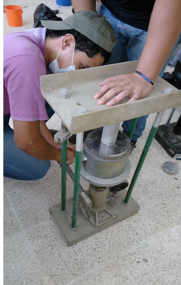
Imagen 11 Realización de la extracción del núcleo
