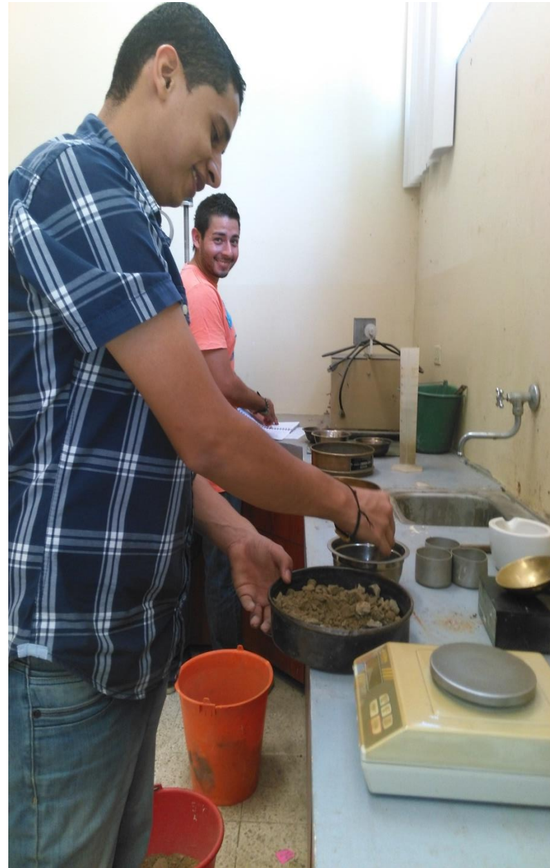
Imagen 5 Tamizado del material para su respectivo ensayo
