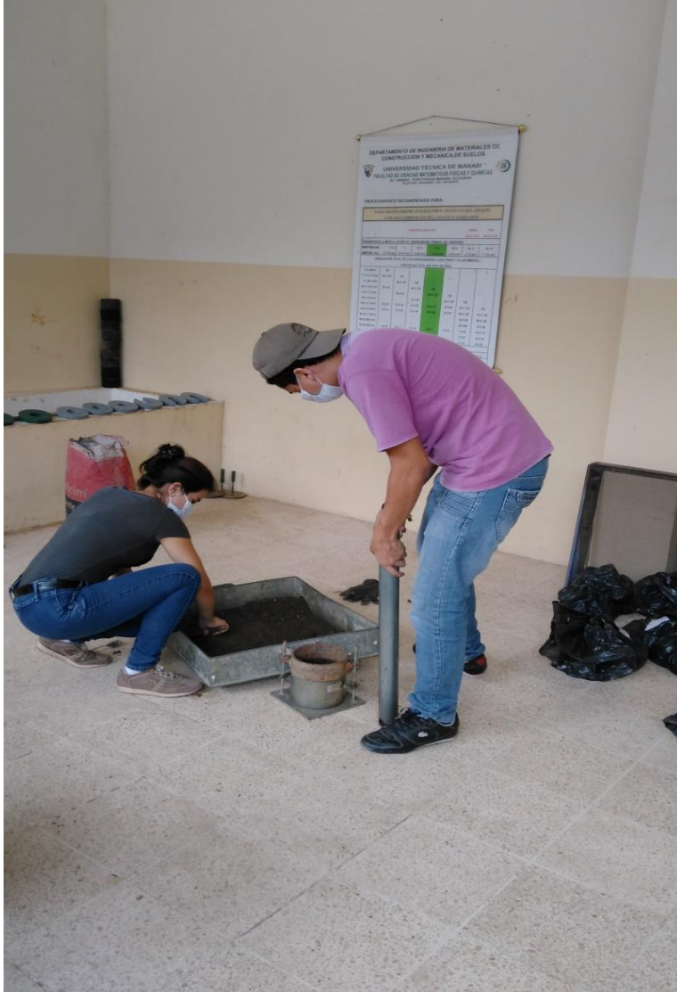
Imagen 12 Realización del ensayo de compactación
