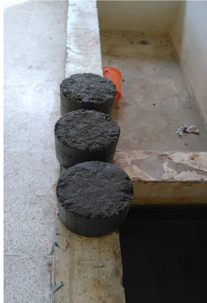
Imagen 15 Ecurrimiento de muestras para su colocación al horno
