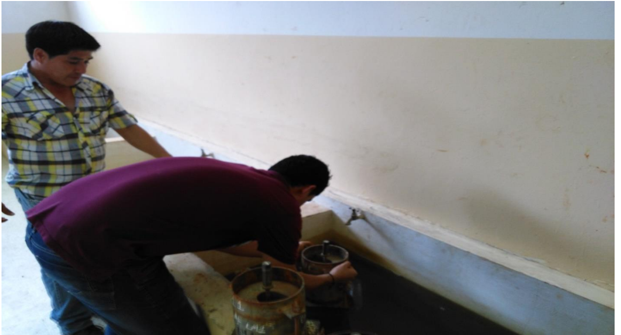
Imagen 9 Colocación de las muestras en la piscina para su respectivo control de hinchamiento
