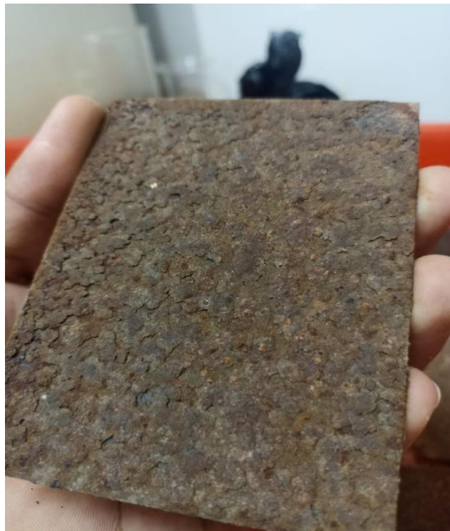
Anexo 17. Afectos de la corrosión en Placa de acero al carbono expuesto al ambiente marino en un tiempo de estudio de 1 año
