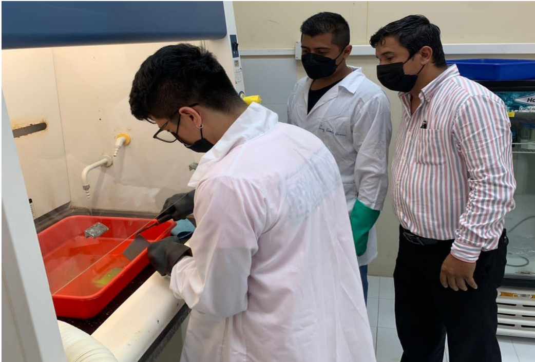
Anexo1. Decapado de las placas de acero al carbono en presencia de nuestro tutor
