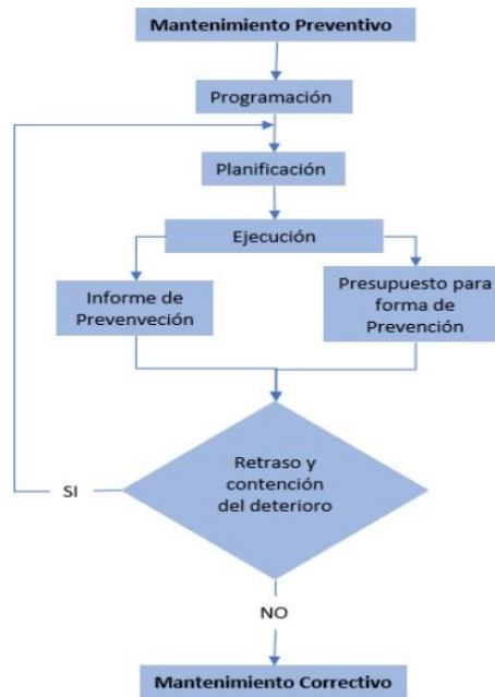
Ilustración 5. Diagrama de flujo del proceso de mantenimiento preventivo de acero estructural.
