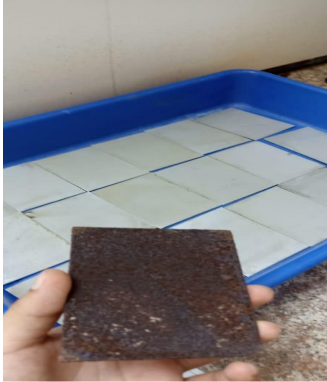
Anexo 16. antes y después de las limpiezas de las placas del acero al carbono
