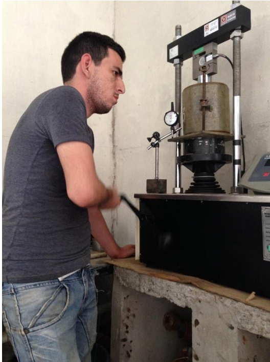
Imagen 17. Determinación de las presiones mediante la maquina Marshall
