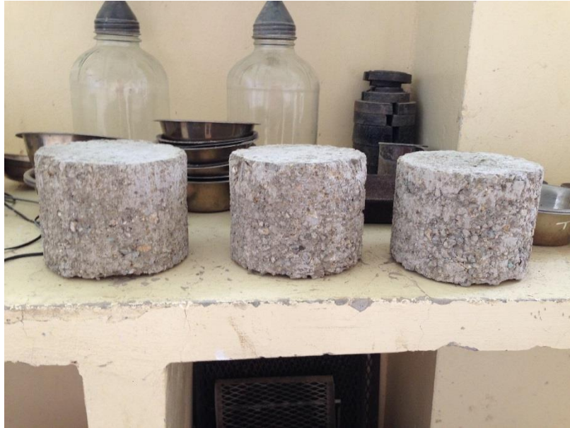
Imagen 27. Cilindros de muestras de suelo-cemento posterior al cepillado.
