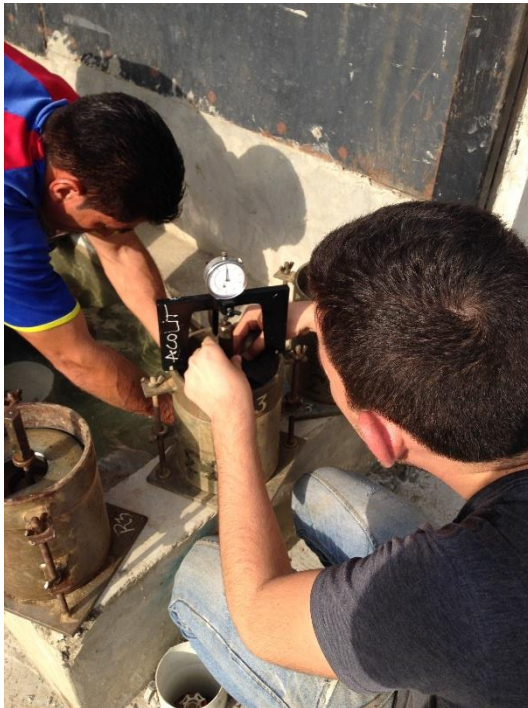
Imagen 18. Calibración del dial para determinar el esponjamiento
