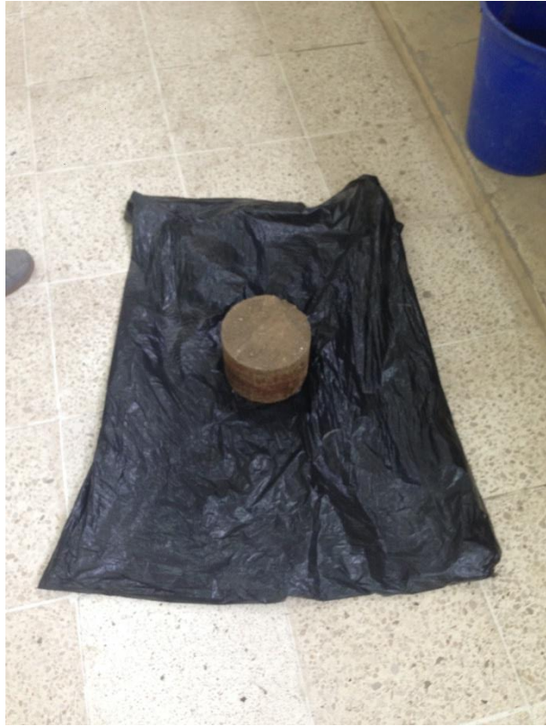
Imagen 21. Cilindro de suelo-cemento antes de su proceso de curado.
