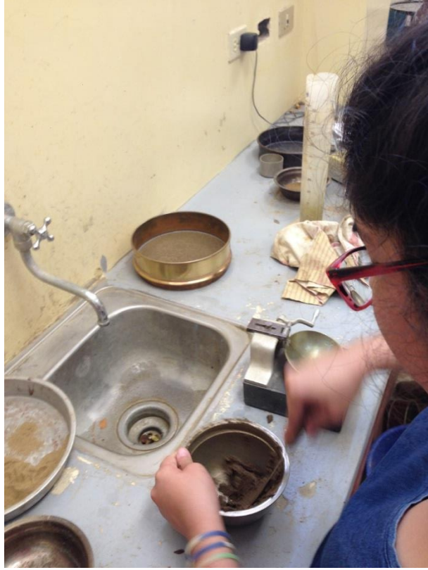
Imagen 9. Preparación de la muestra para determinar el límite líquido
