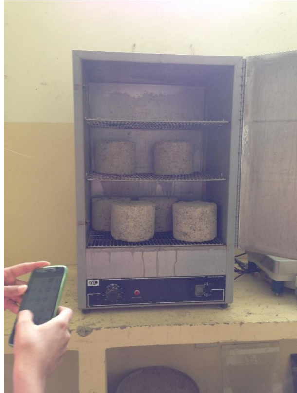
Imagen 25. Cilindros de suelo-cemento en el horno luego del proceso de inmersión
