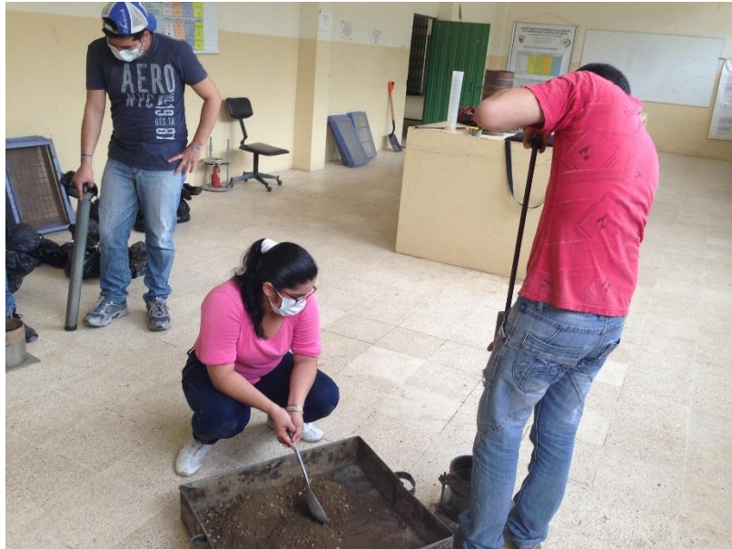
Imagen 20. Preparación de la muestra estabilizada con cemento en el molde de proctor
