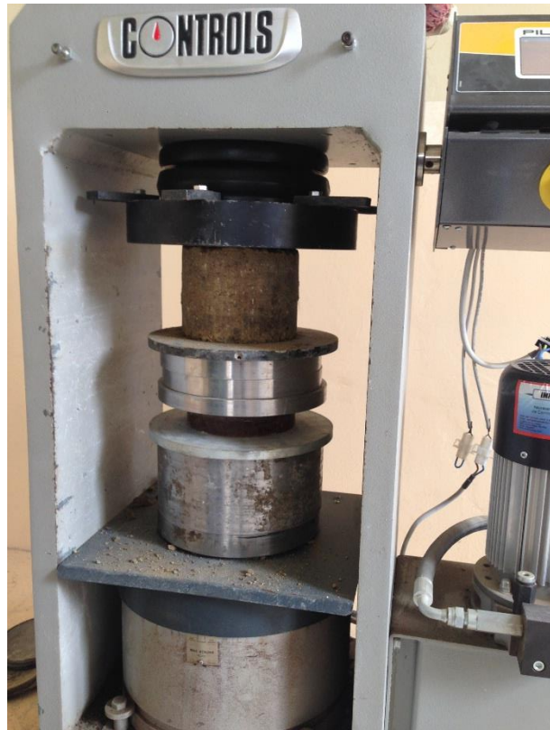
Imagen 23. Proceso de compresión de los cilindros de suelo-cemento
