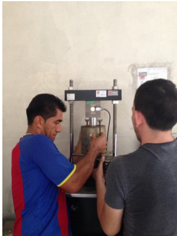
Imagen 16. Colocación de los moldes en la máquina Marshall
