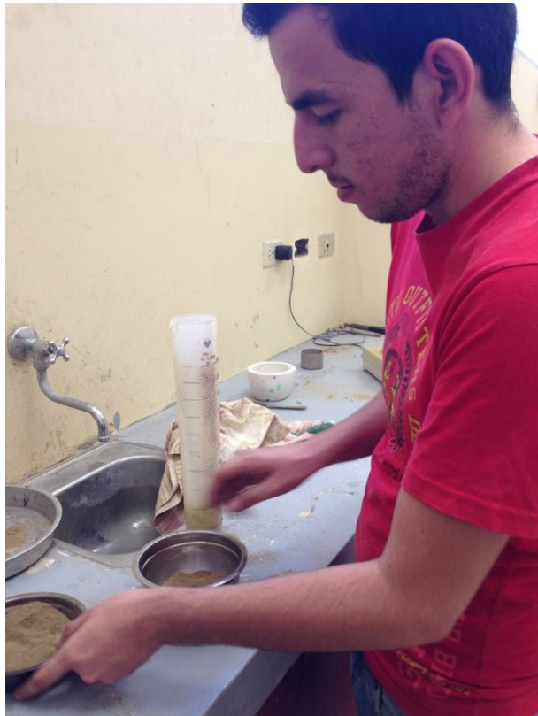
Imagen 8. Preparación de la muestra para los límites de consistencia
