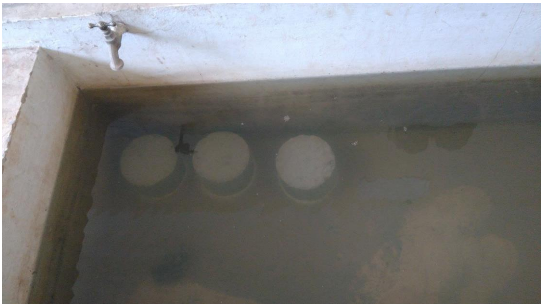
Imagen 24. Cilindros de suelo-cemento para el ensayo de humedecimiento y secado
