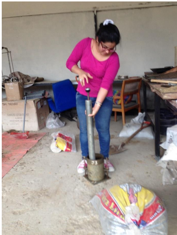
Imagen 14. Compactación la muestra en el molde de C.B.R.
