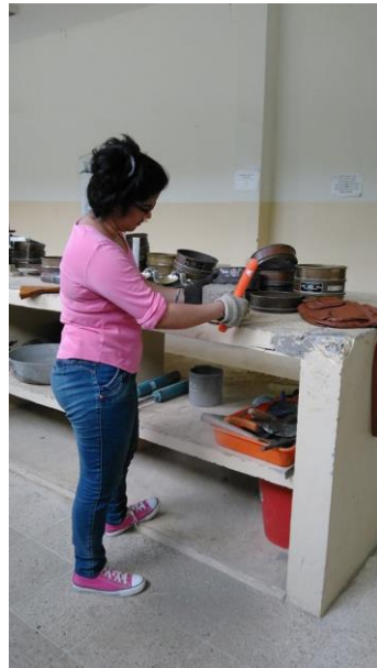
Imagen 26. Proceso de raspado con cepillo metálico de los cilindros posterior al secado en horno para ensayo de humedecimiento y secado
