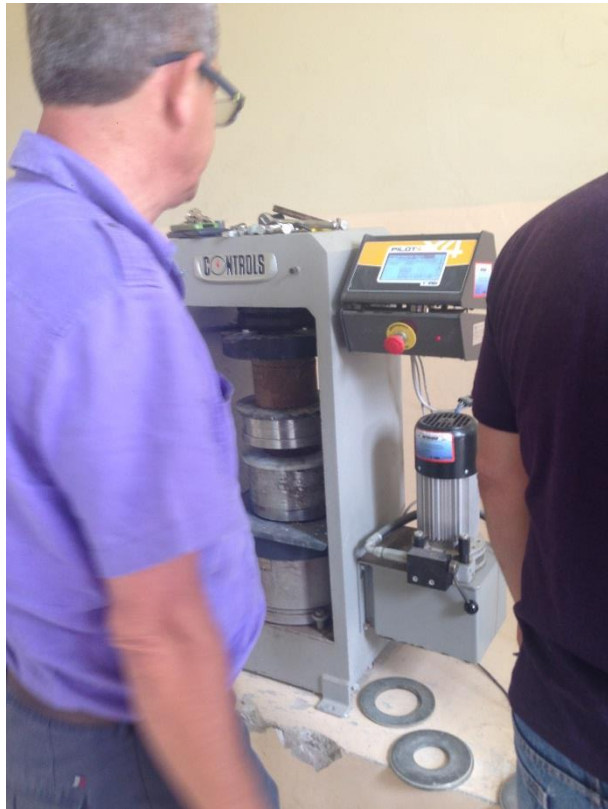
Imagen 22. Ensayo de resistencia a compresión
