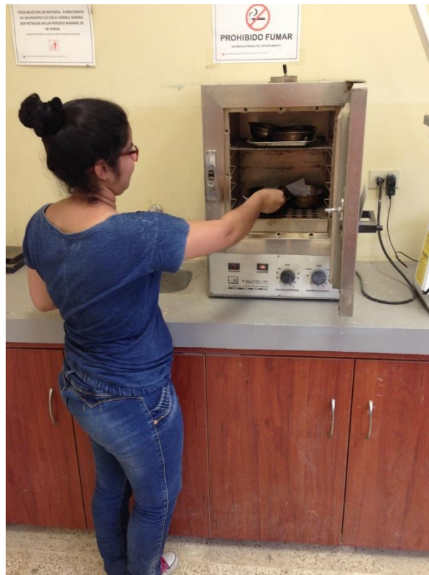
Imagen 6. Muestras en el Horno para determinar su humedad natural
