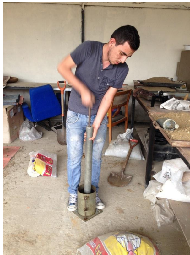
Imagen 12. Golpes a la muestra en el ensayo de C.B.R.
