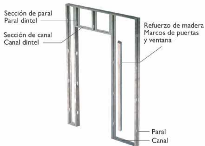
Imagen N° 16: Estructura para la colocación de puertas
