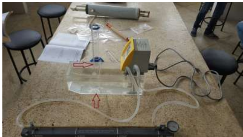
Figura 18. Experimento mostrando la dilatación de líquidos.
