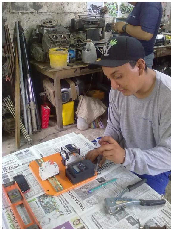
INSTALCIÓN DE RIELES PARA LOS EQUIPOS
