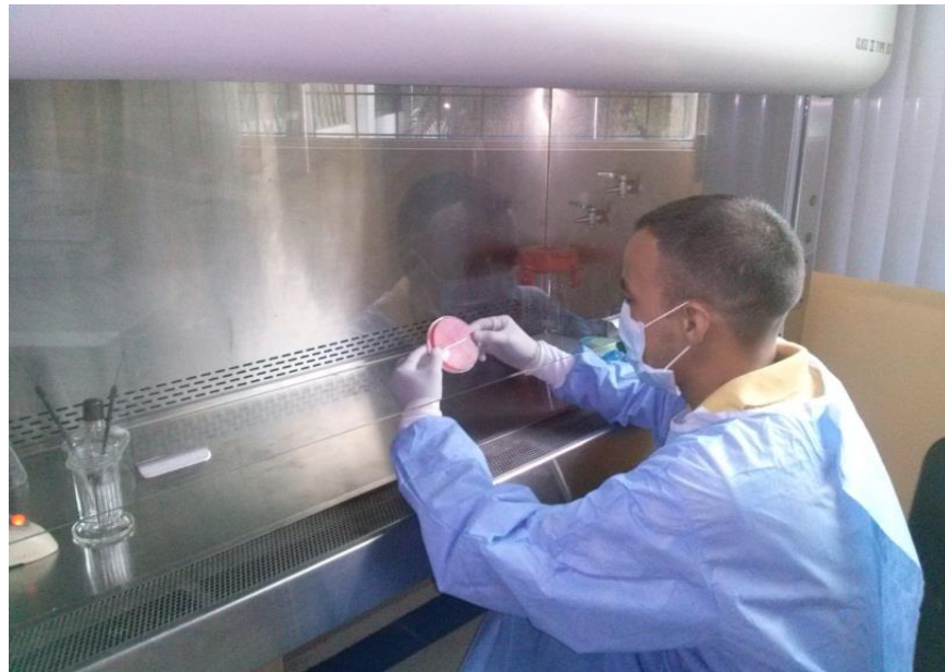
Cámara de seguridad biológica, dentro de la misma se realizan las manipulación y siembra de muestras biológicas como la de los hemocultivos
