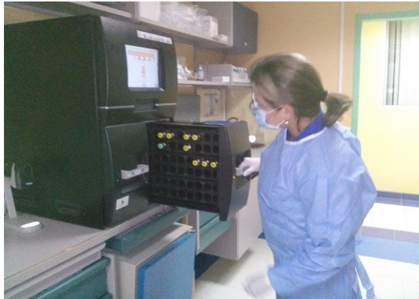
Equipo incubador de hemocultivo llamado Bact/alert: máquina donde se incuban las botellas de los hemocultivos previamente tomadas
