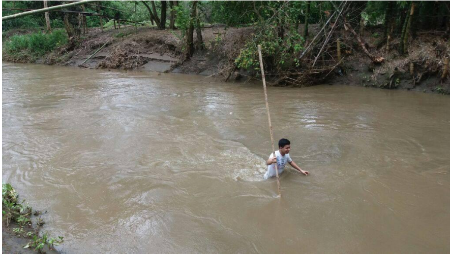
Figura 10. Parte del proceso de la medición del caudal en el sitio San Eloy.
