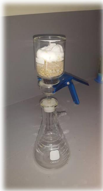
Sistema de filtración (Algodón-Arena-Biomasa de lechuguín-Carbón Activado)
