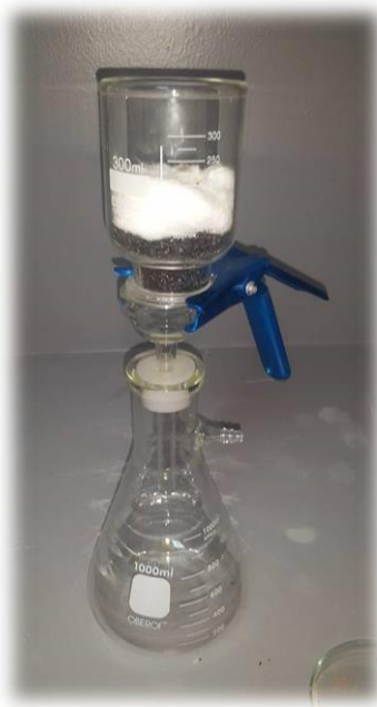
Sistema de filtración (Algodón-Carbón Activado)
