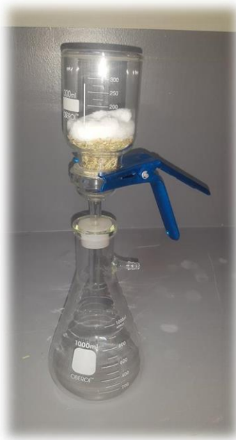
Sistema de filtración (Algodón-Biomasa de lechuguín)
