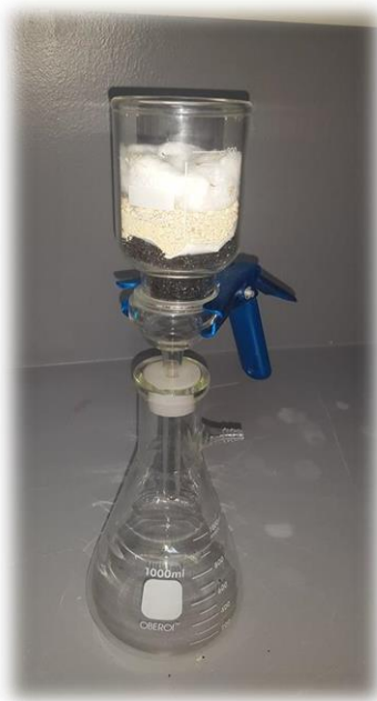
Sistema de filtración (Algodón-Zeolita-Carbón Activado)
