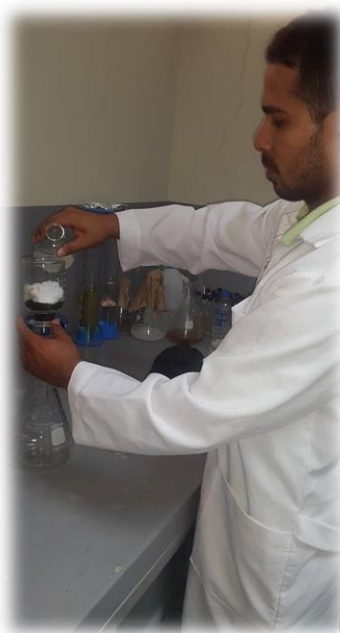
Filtrado del agua contaminada
