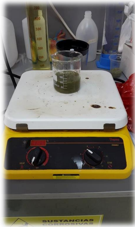
Adsorción de iones de cromo y plomo con la biomasa de lechuguín a diferentes intervalos de tiempo
