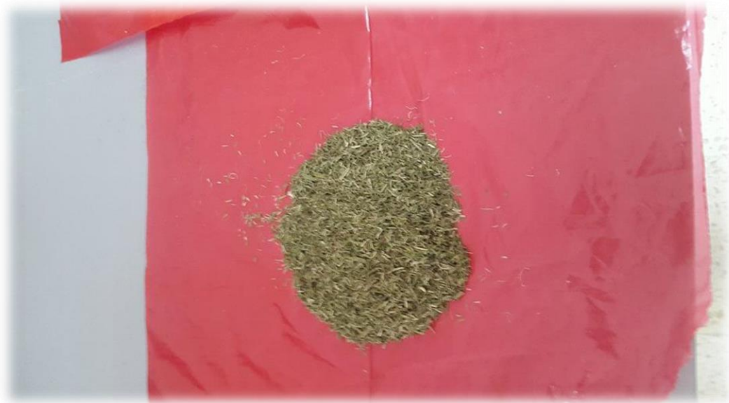
Tamaño de biomasa seca óptima para la filtración (0,180 mm)
