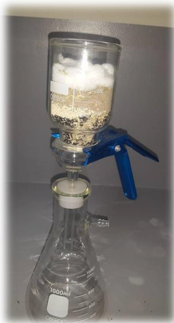
Sistema de filtración (Algodón-Arena-Zeolita-Carbón Activado)
