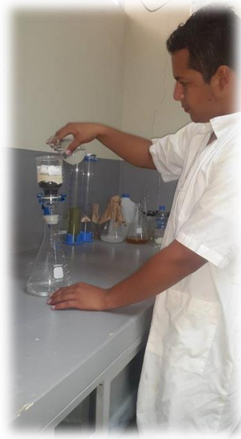
Filtrado del agua contaminada
