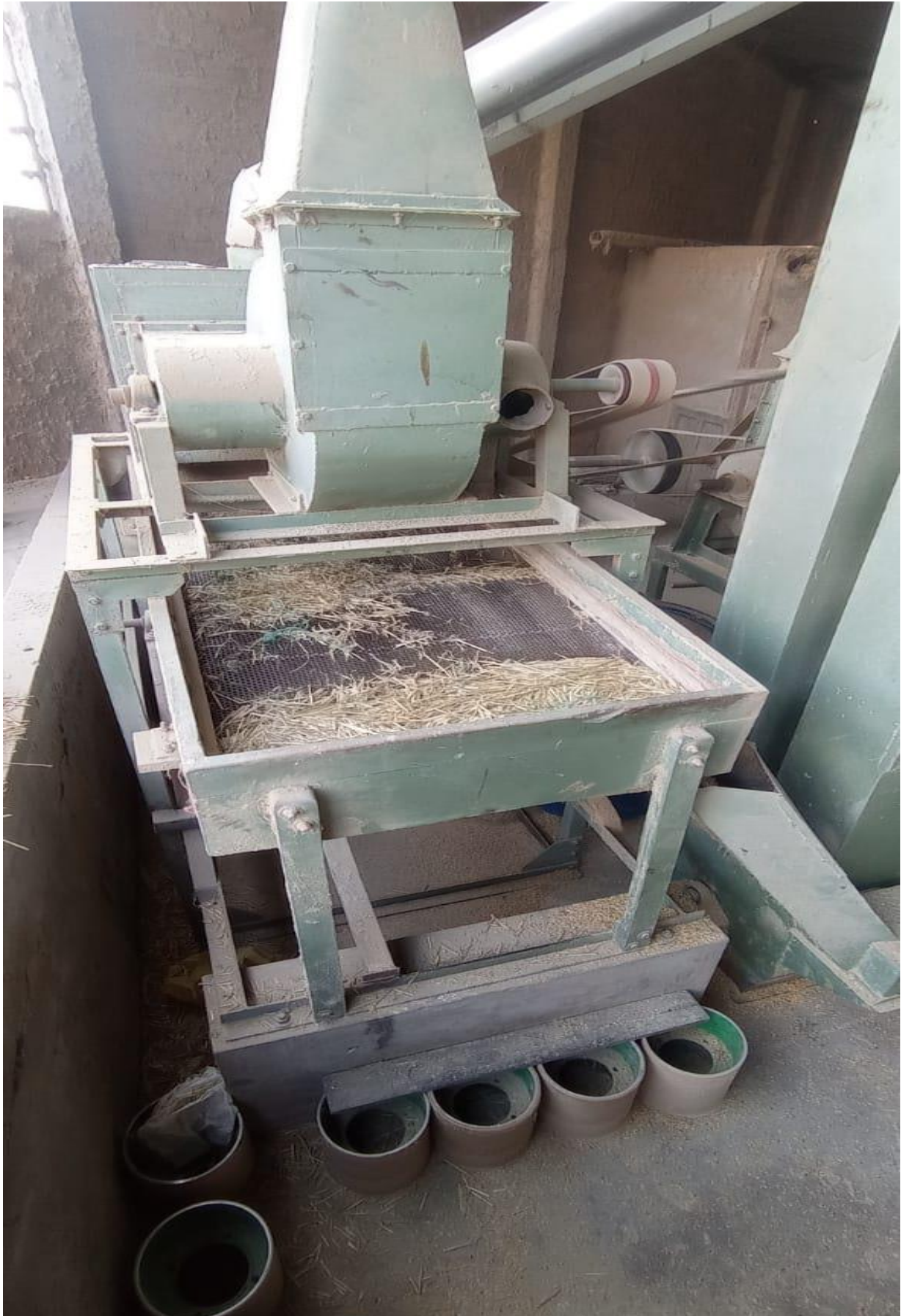
Ilustración 10 - Proceso de prelimpiadora de arroz
