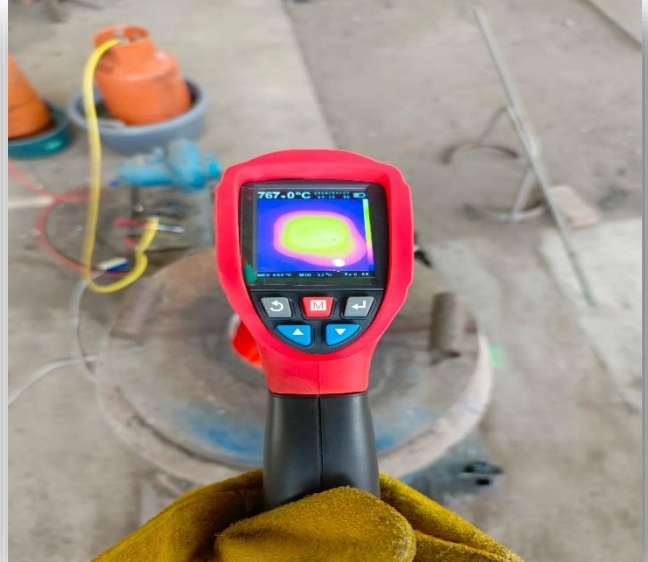
Anexo 3. Implementación de pirómetro para calcular el nivel de temperatura del horno.
