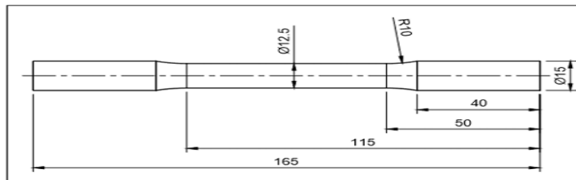
Figura 11. Diseño y dimensiones de una probeta según ASTM E8
