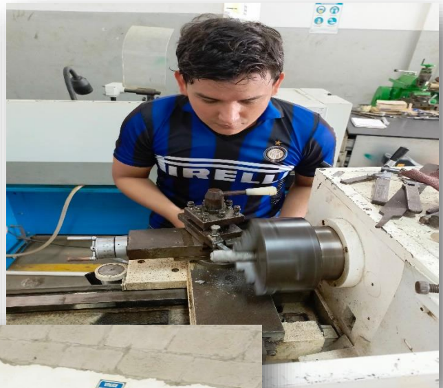
Anexo 4. Obtención de las probetas y mecanizado de las mismas.
