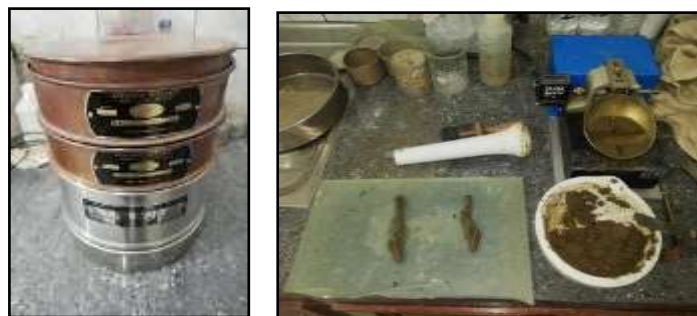
Ilustración 13. Ensayo de límites de Aterberg método INEN 685
