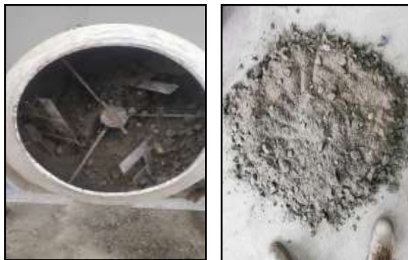
Ilustración 20. Mezcla de los componentes del suelo cemento.
