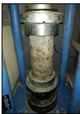
Ensayo de resistencia a la compresión simple.
