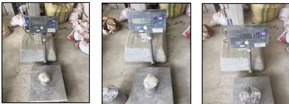
Ilustración 29. Dimensiones y pesos de los especímenes previo al ensayo de pulso ultrasónico.
