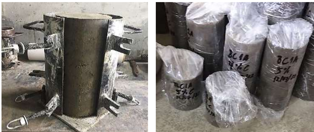
Ilustración 26. Curado de los especímenes de diferentes edades y tamaños.
