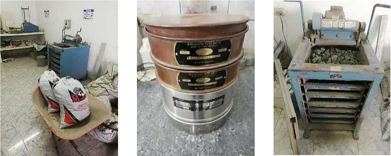
Ilustración 51. Proceso de ensayos de granulometría del material granular.
