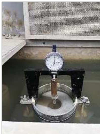
Ilustración 17. Lectura de los diales en el esponjamiento del CBR
