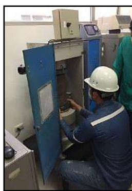
Ensayo de resistencia a la compresión simple.
