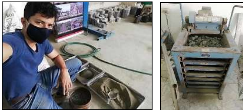
Ilustración 11. Ensayo Granulométrico del material granular base clase 1 A.
