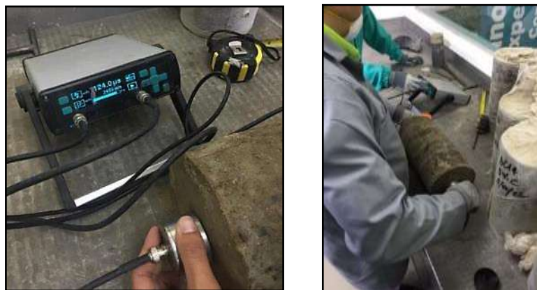
Ilustración 28. Equipo utilizado en el ensayo de pulso ultrasónico
