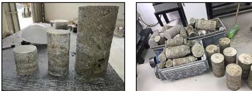
Ilustración 32. Fotografías de cilindros de base estabilizada con cemento tipo GU después resistir su máxima carga.
