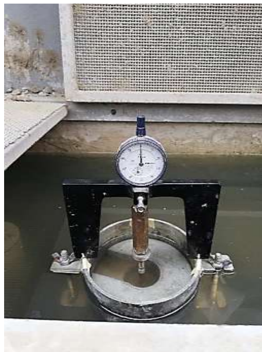
Ilustración 53. Ensayo de Proctor modificado y CBR.
