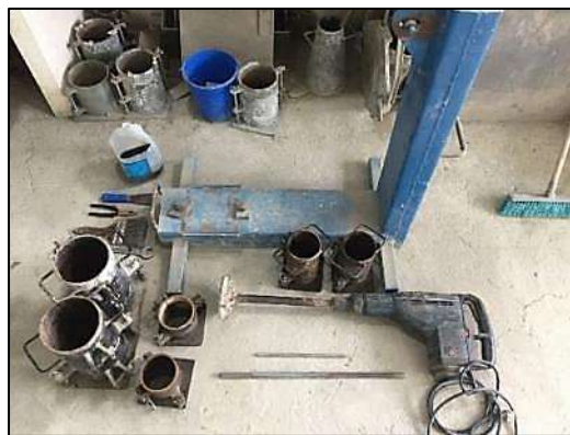
Ilustración 24. Instrumentos para llevar a cabo la compactación.
