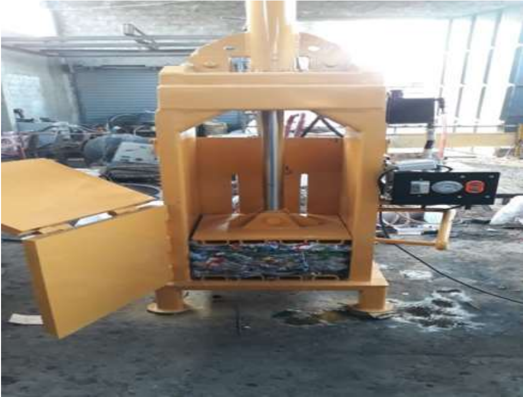
TRABAJO DE COMPACTACION DE LA MAQUINA
