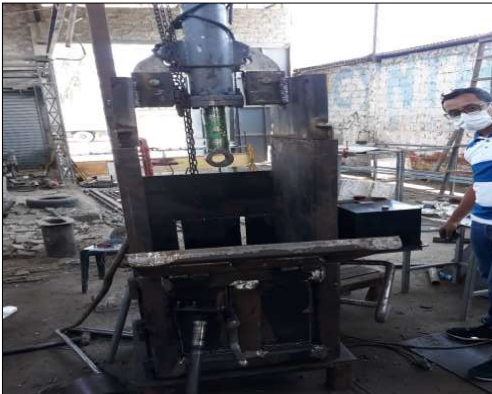
POSTURA DEL CILINDRO HIDRAULICO Y LA BOMBA DE ENGRANAJE
