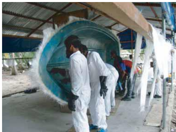
Figura 7. Colocación del mat de fibra de vidrio
