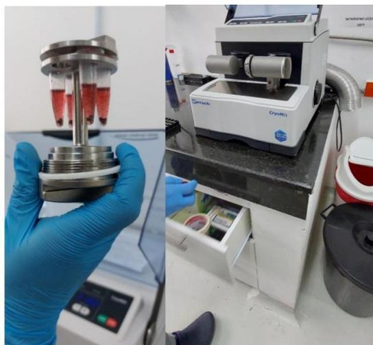
**Anexo 17.** Preparando el homogenizado de los insectos mediante trituración con un pistilo en método de trizol
