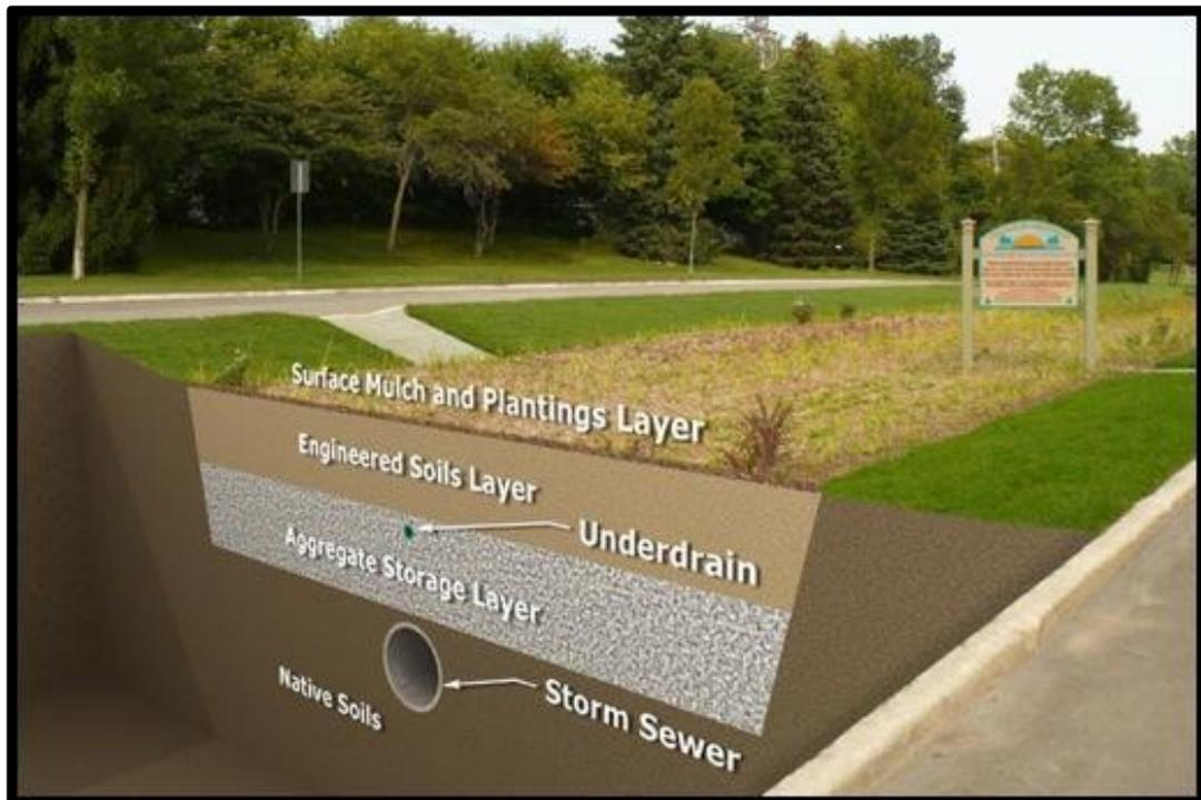
**Figura n° 2.** Dren filtrante con capas granulares
