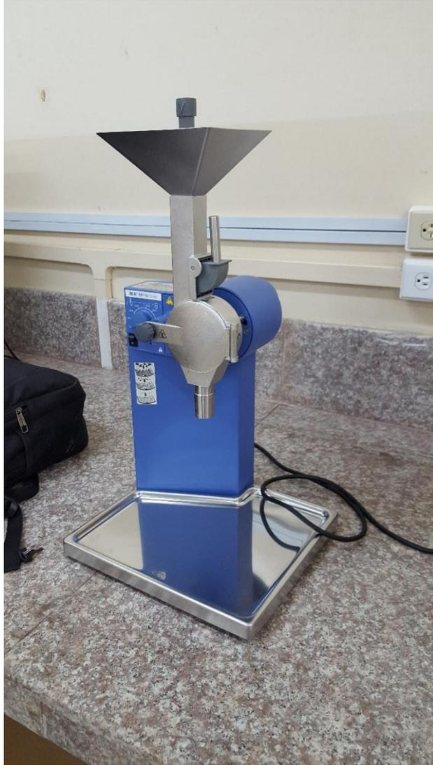
Foto del molino analítico instalado.
