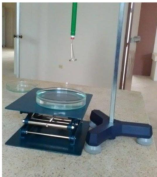
Anillo de tención y plataforma de levanta
