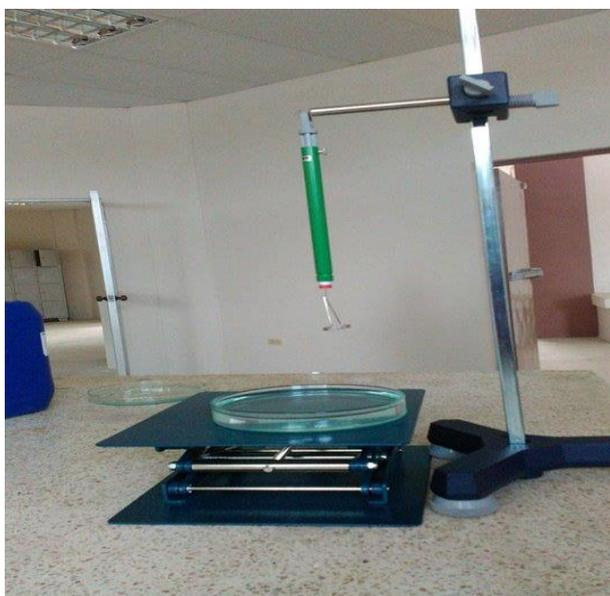
Realizamos el ensayo en el laboratorio y procedemos a subir la balanza hasta que el anillo tope con el agua y rompamos el agua procedemos a bajar lentamente la
