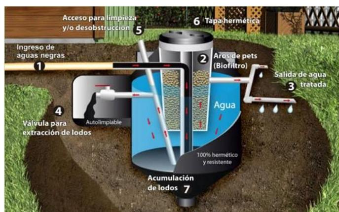
**Fig. 9** Estructura de un biodigestor pre-fabricado.
