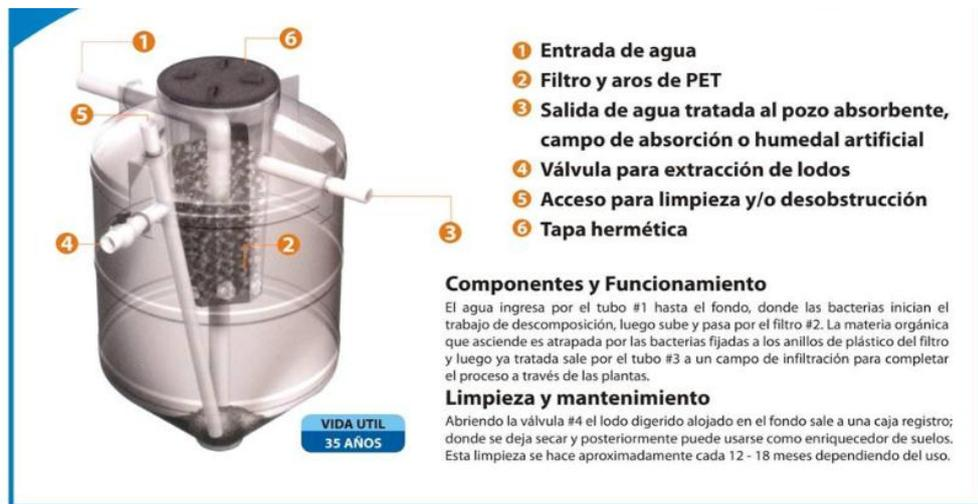
**Fig. 10** Componentes del biodigestor
