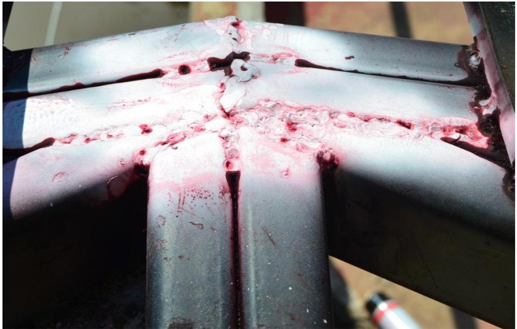
**Fig.4.15**Revelado de las fisuras
