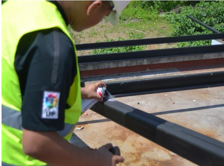
Fig. 2.34 Aplicación del Revelador
