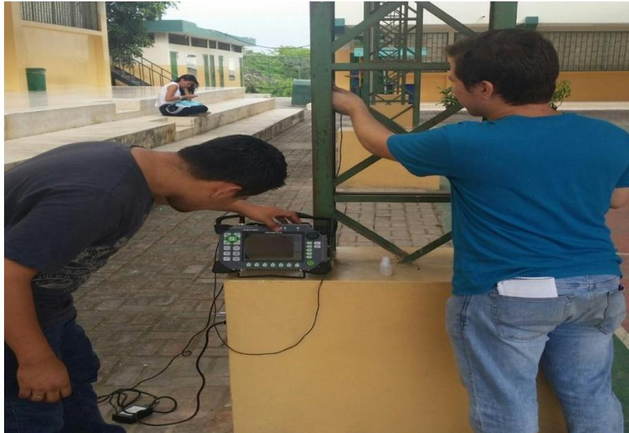
**Fig.4.26 Inspección por ultrasonido**
