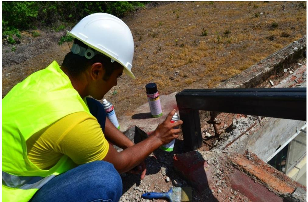
**Fig. 4.14 Aplicación de la tinta penetrante**
