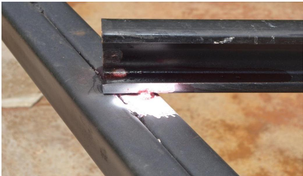
**Fig.4.16** Revelado de las fisuras
