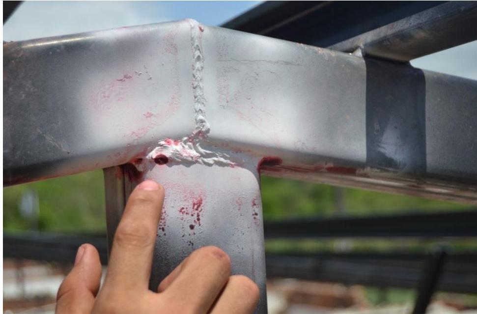
**Fig.4.17 Indicación de la fisura**
