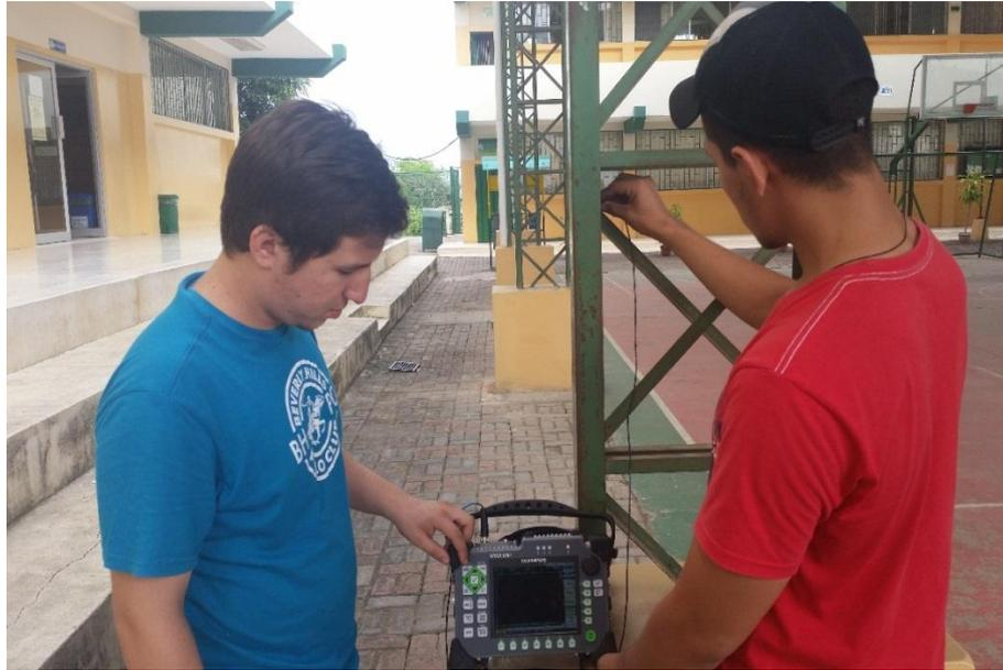
**Fig.4.25 Inspección por ultrasonido**
