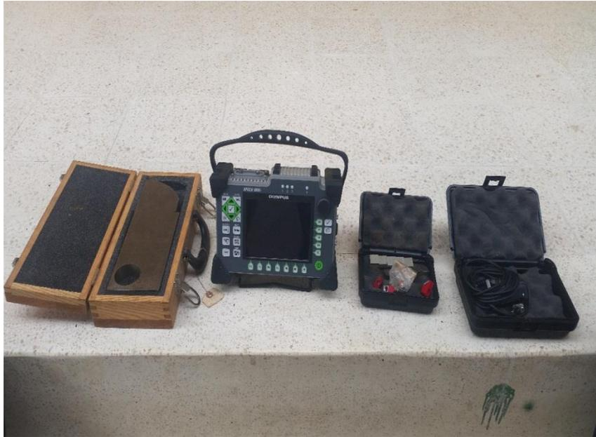
**Fig.4.23 Equipo de inspección de ultrasonido**
