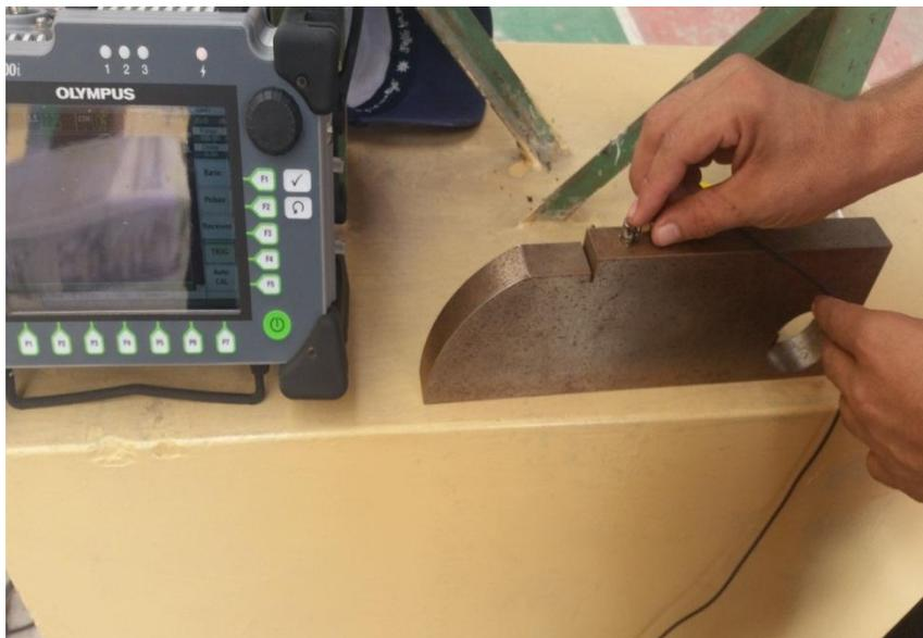
**Fig. 4.24 Calibración del equipo de ultrasonido**
