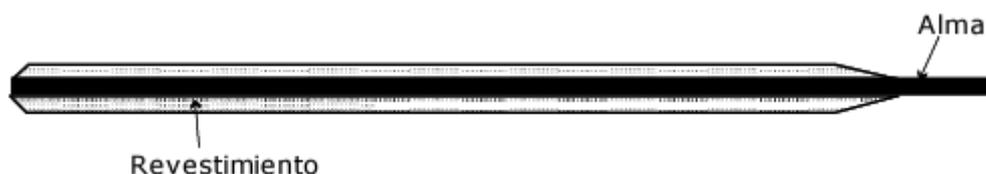
Fig. 2.15 Estructura básica de un electrodo
