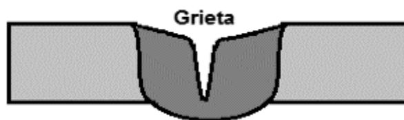
Fig. 2.18 Grieta debido a una separación grande de las piezas
