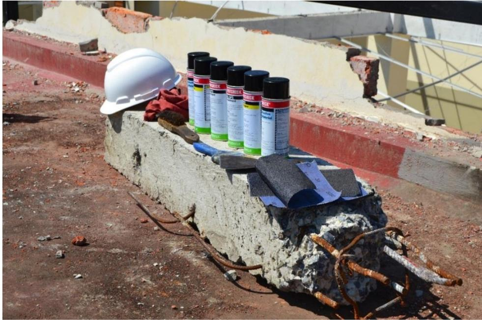
**Fig. 4.21 Kit de líquidos penetrantes, instrumentos de limpieza**
