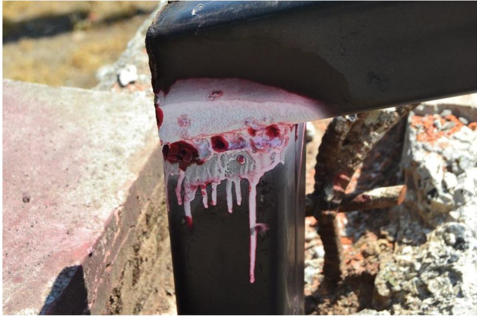
**Fig.4.19** Discontinuidades en el cordon de soldadura
