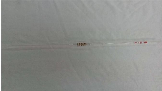
Foto 13.1.4. Pipeta de 10 ml Aforada
