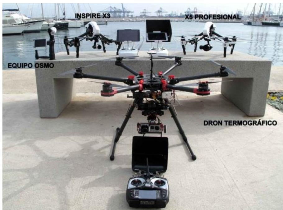
**Figura 6. Dron con cámara termográfica incorporada**
