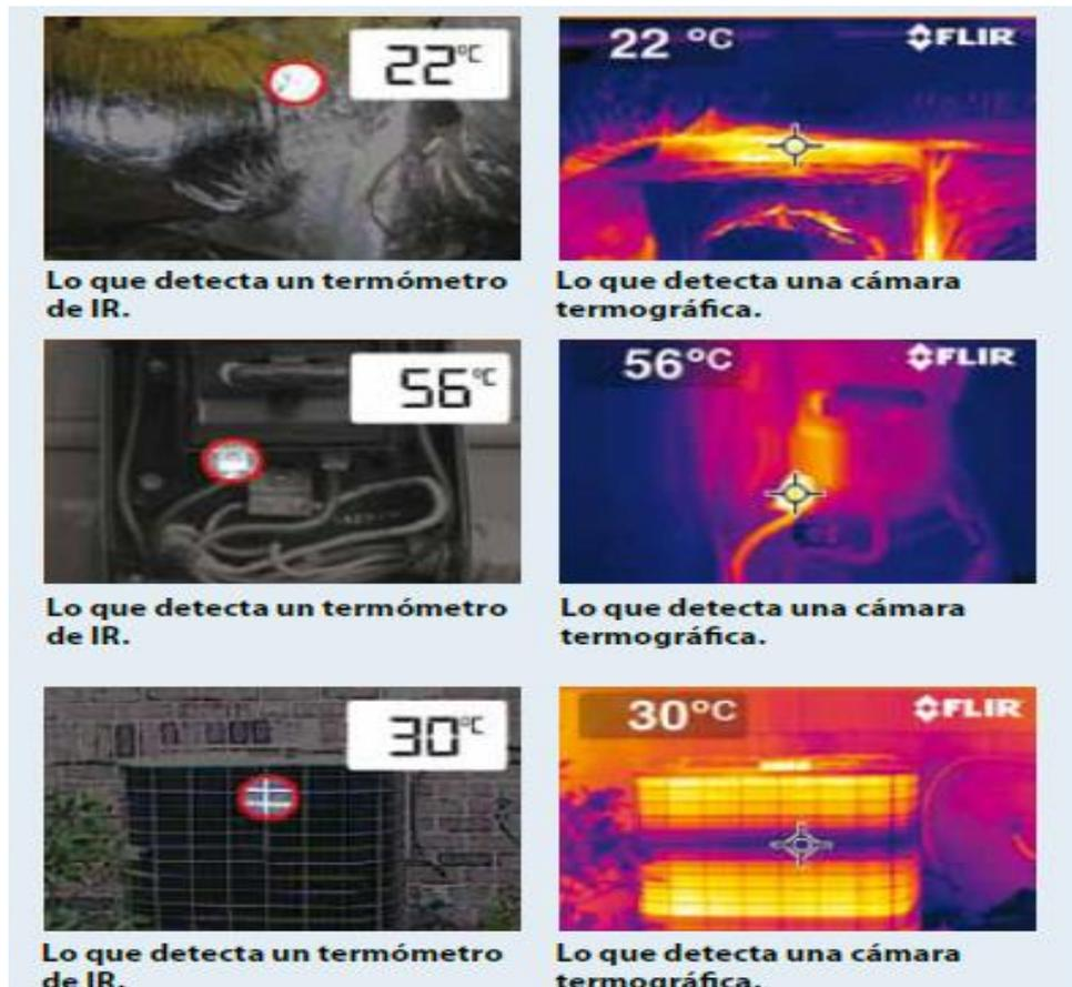
**Figura 12. Pirómetro vs cámara FLIR i3**
