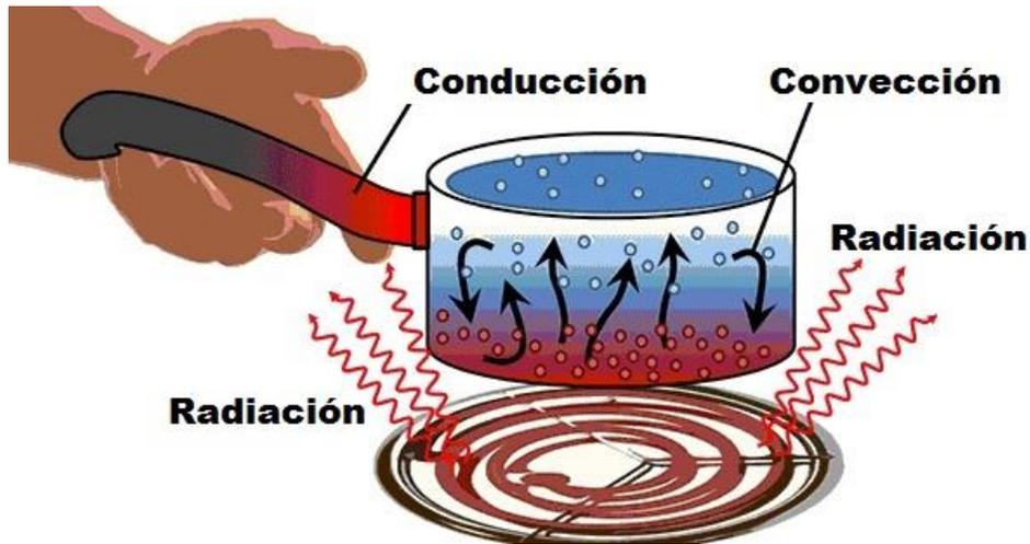
**Figura 1. Tipos de transferencia de calor**
