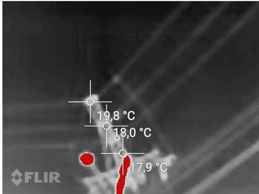
**Figura 17. Termografía realizada con una cámara termográfica no profesional marca CAT S60, en el poste 483**
