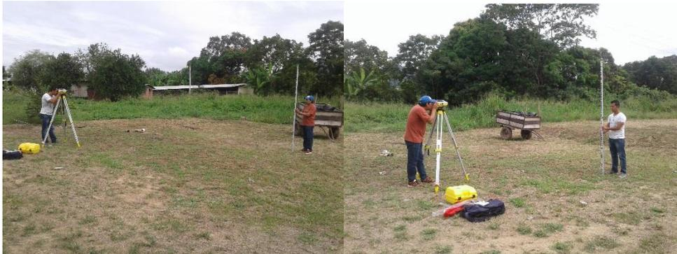
*Altimetría con Nivel electrónico digital GEOMAX DZL700*
