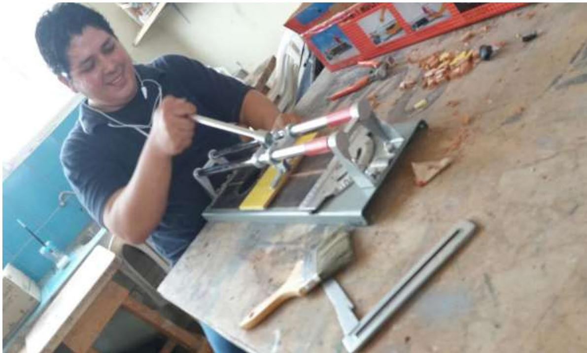
Cortando cerámica para moldear acorde a la figura que se va a estructurar
