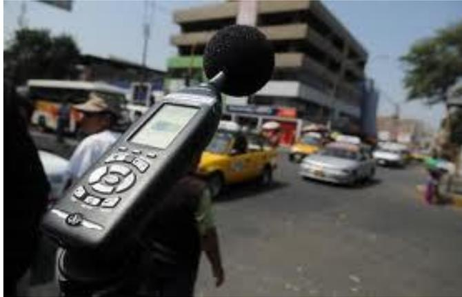
*Figura #6: medición del nivel de ruido.*
