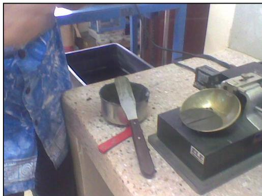
Rotando la palanca, se hace subir y bajar la copa al ritmo de 2revoluciones/segundo, hasta que la muestra se una en la parte inferior del canal, en una longitud de 1/2". Se
