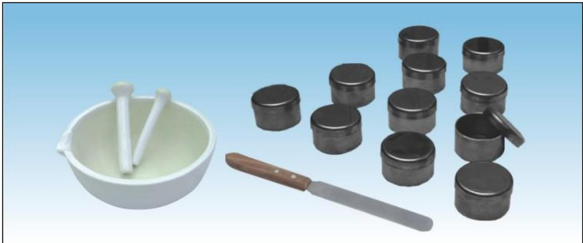
**a.) bandeja de evaporización:** se la utiliza para mezclar dicho material, hasta obtener la plasticidad adecuada, el recipiente es de porcelana la cual tiene un diámetro aproximadamente 11,5cm (4<sup>1</sup>/<sub>2</sub>").
