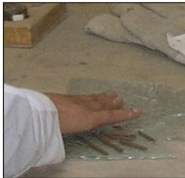
Cuando el diámetro del rollo llegue a 3mm se lo rompe en 6 u 8 pedazos, se lo amasa nuevamente con los dedos para que estén uniformes los rollitos y para luego ser pesados y colocados en el horno a una temperatura adecuada.
