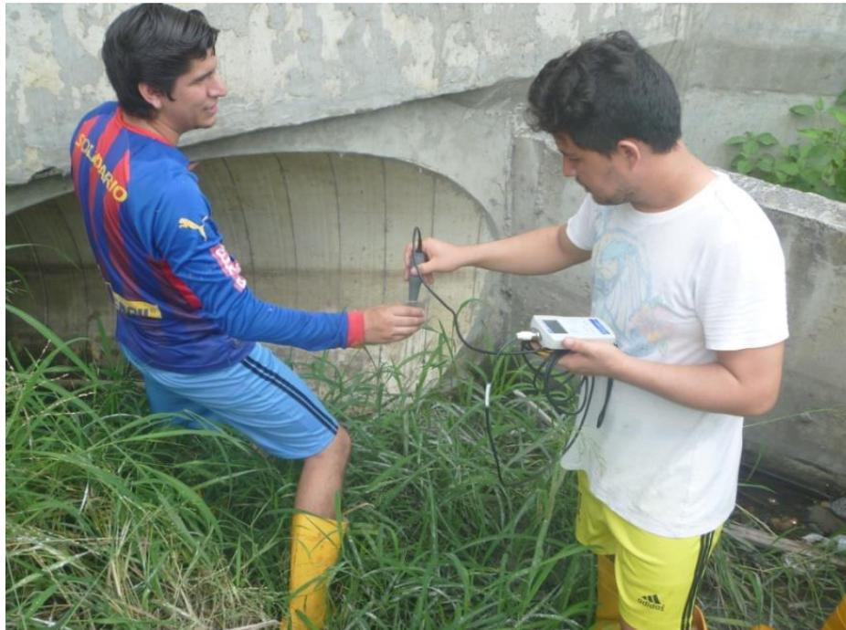
*Gráfico No.42.* Toma de muestras con el medidor de oxígeno disuelto MW600. Fotografía tomada por los autores de esta tesis en el Río Portoviejo. [06, enero, 2015]
