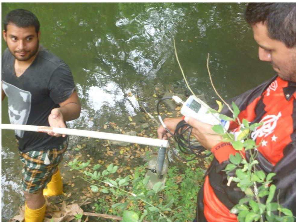
*Gráfico No.44.* Toma de muestras con el medidor de oxígeno disuelto MW600. Fotografía tomada por los autores de esta tesis en el Río Portoviejo. [09, enero, 2015]
