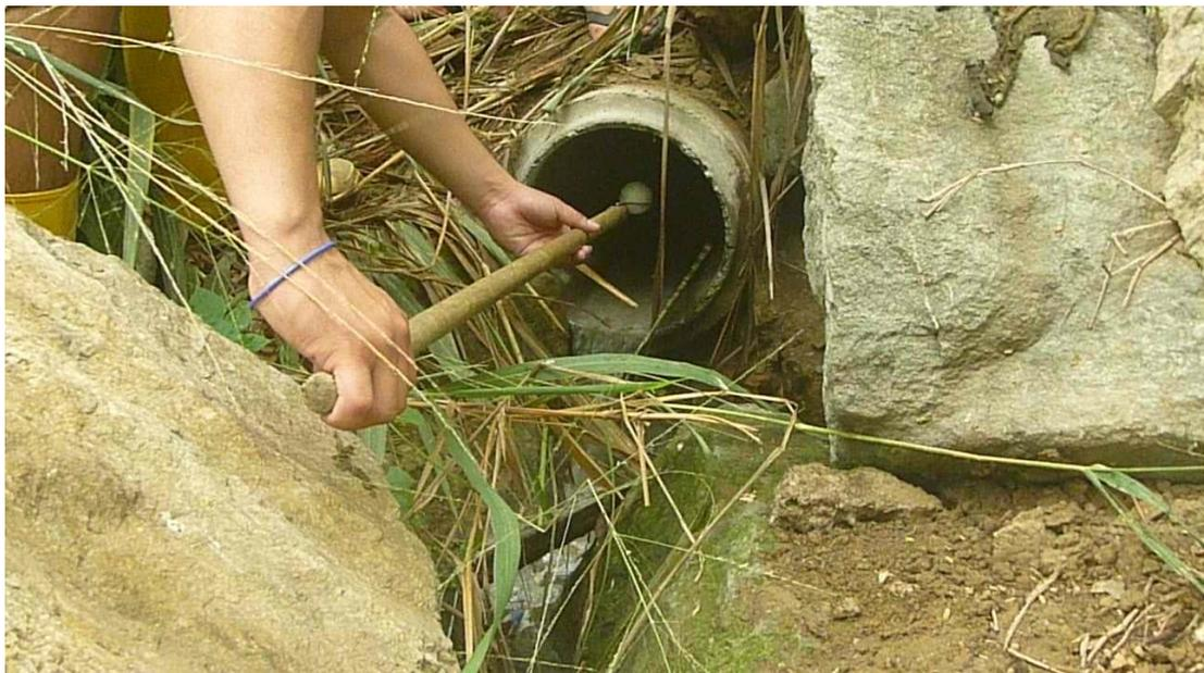
*Gráfico No.46.* Flotadores utilizados para la estimación del tiempo en el cálculo de caudales por el método de las secciones. Fotografía tomada por los autores de esta tesis en el Río Portoviejo. [20, enero, 2015]
