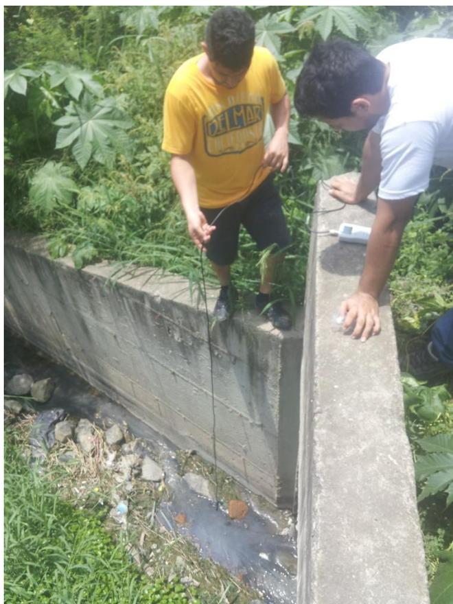
*Gráfico No.51.* Toma de muestras con el medidor de oxígeno disuelto MW600. Fotografía tomada por los autores de esta tesis en el Río Portoviejo. [14, abril, 2015]
