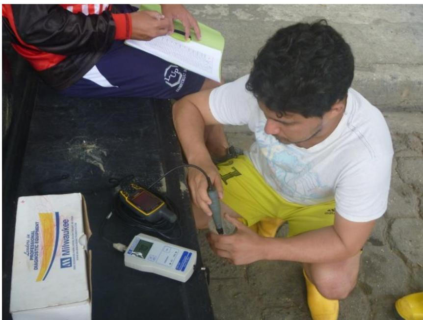
*Gráfico No.43.* Calibración del medidor de oxígeno disuelto MW600. Fotografía tomada por los autores de esta tesis en el Río Portoviejo. [09, enero, 2015]
