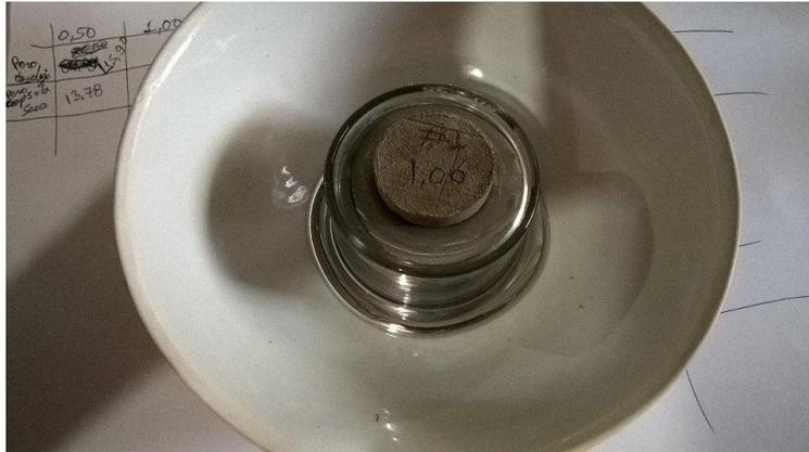
Luego de esperar tres días y que la muestra no presente cambios volumétricos por pérdida de humedad se realiza el ensayo del Límite de contracción de la mezcla Arcilla-Cal
