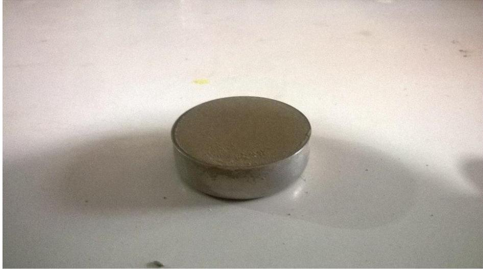
Luego de esperar tres días y que la muestra no presente cambios volumétricos por pérdida de humedad se realiza el ensayo del Límite de contracción del suelo natural
