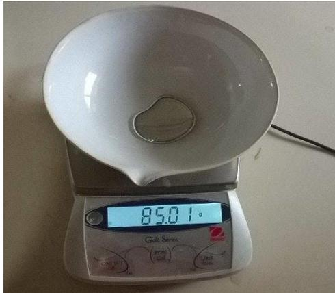
Peso de las muestras secas para del ensayo de límite de contracción en estado natural y con la mezcla Arcilla-Cal
