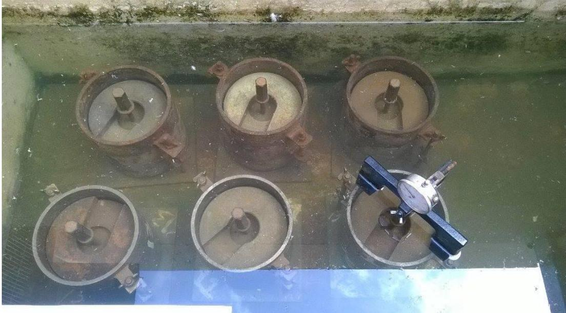
Retiro de las muestras del ensayo CBR
