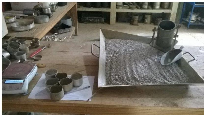
Ensayos de proctor de las muestras tomadas
