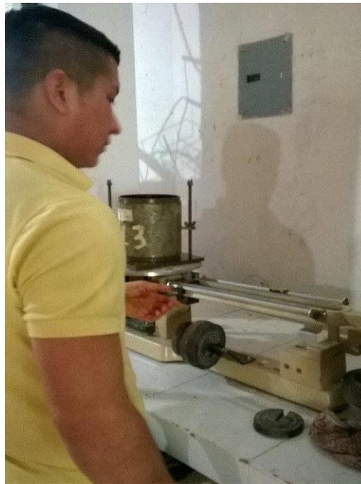
Ensayo de prueba de CBR en la maquina Marshall
