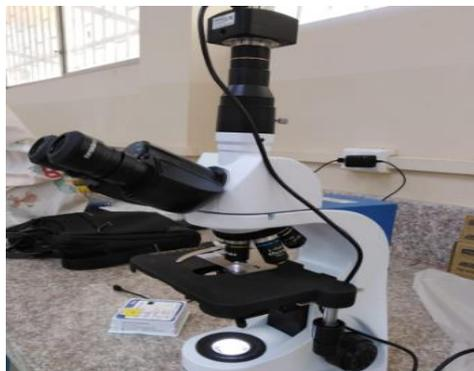
Microscopio óptico trinocular standard con cámara. (OPTIKA B-383PLi)
