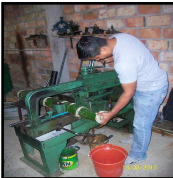
**Imagen # 33 PROBETAS DE CAÑA PARA EL RESPECTIVO ENSAYO**
