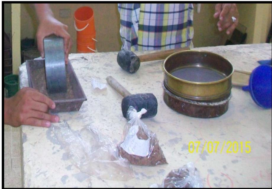
El límite líquido y plástico se los determina, realizando ensayos de laboratorios, al conocer el valor de estos dos ensayos, se puede encontrar el índice de plasticidad del suelo.
