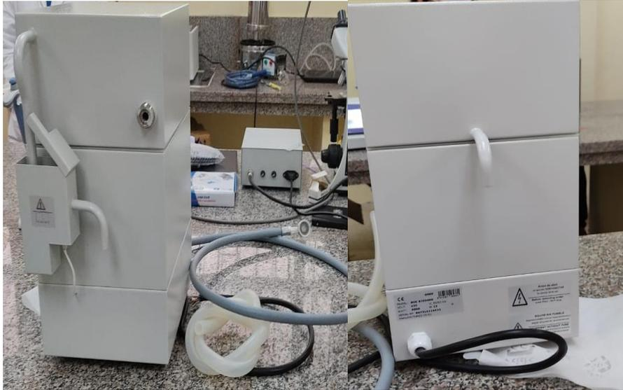
**Figura 5.-** Destilador de agua 4 litros 220v y accesorios
