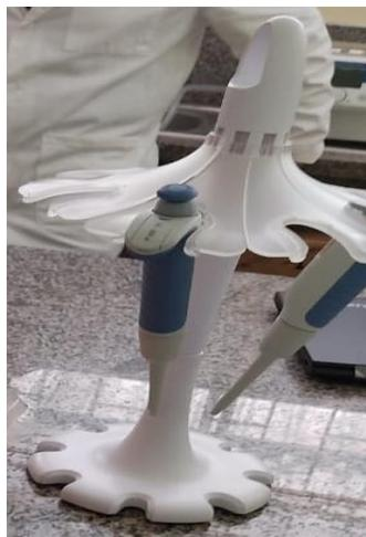
**Figura 6.-** Micropipeta y soporte universal micropipetas 8pts.
