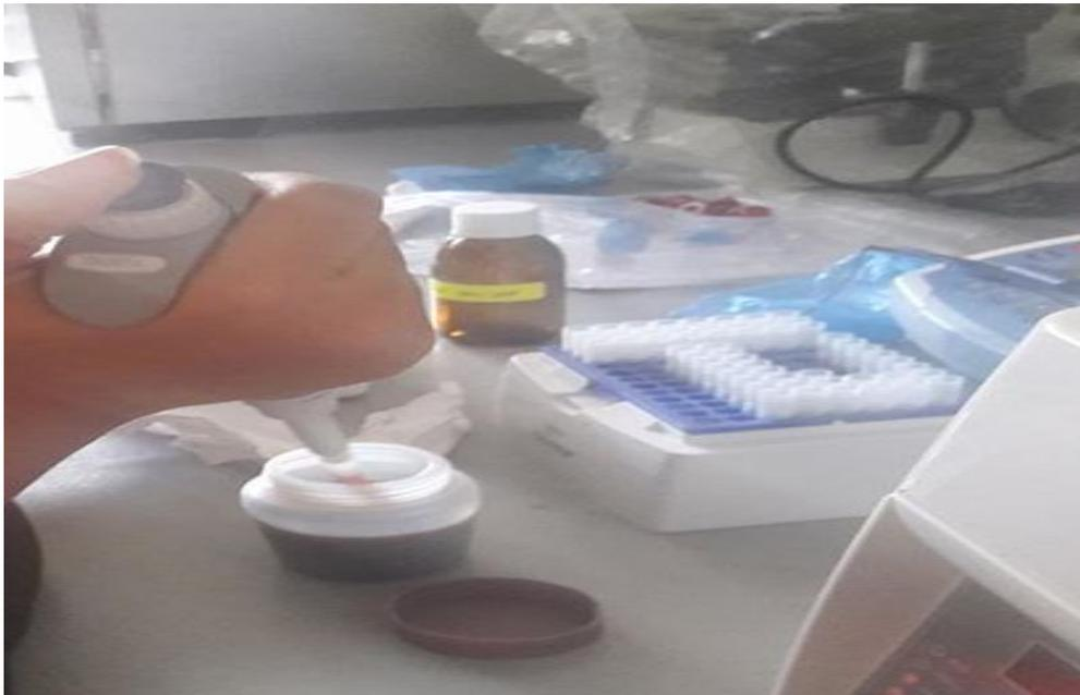
**Ilustración 6.** Preparación de la solución del tampón Buffer fosfato sódico y control de pH.
