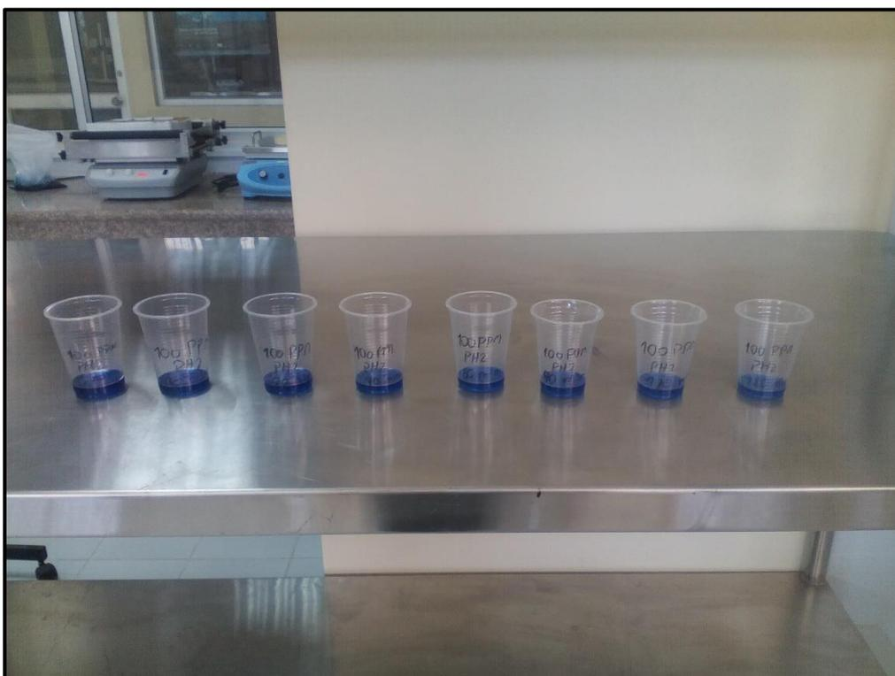
Muestras listas para la medición de concentración en el espectrofotómetro
