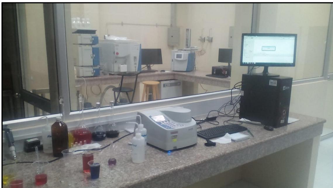
Medición de las muestras con el espectrofotómetro
