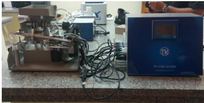
**Figura 2.- Equipo para envasado de pajuelas de 0,50 ml Modelo TK CCM-Jet1000**
