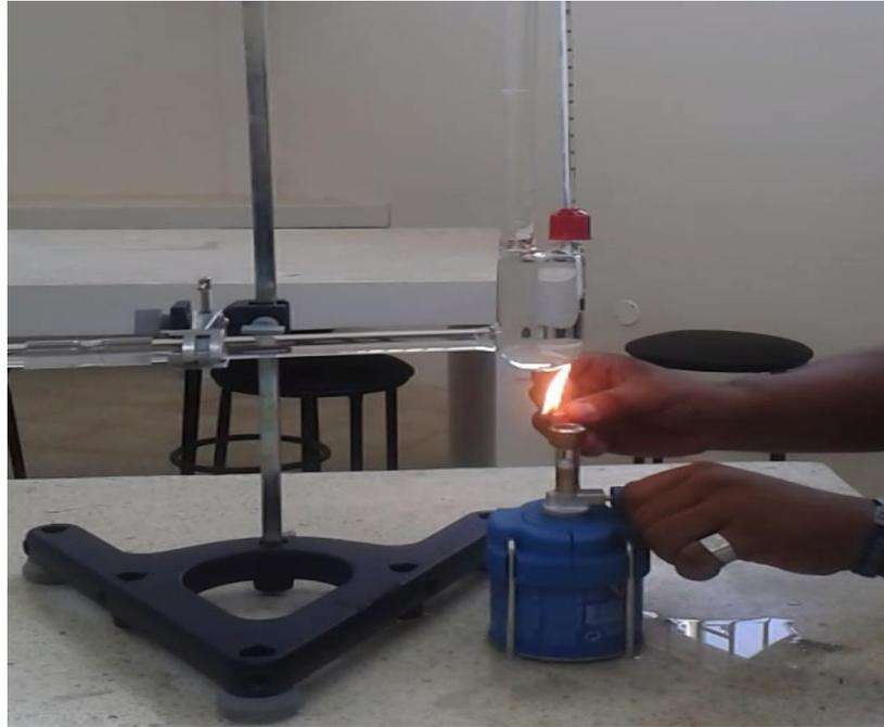
Instalación de equipo para ensayo de calor absorbido
