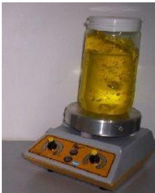
**Ilustración 20:** Agitador Magnético
