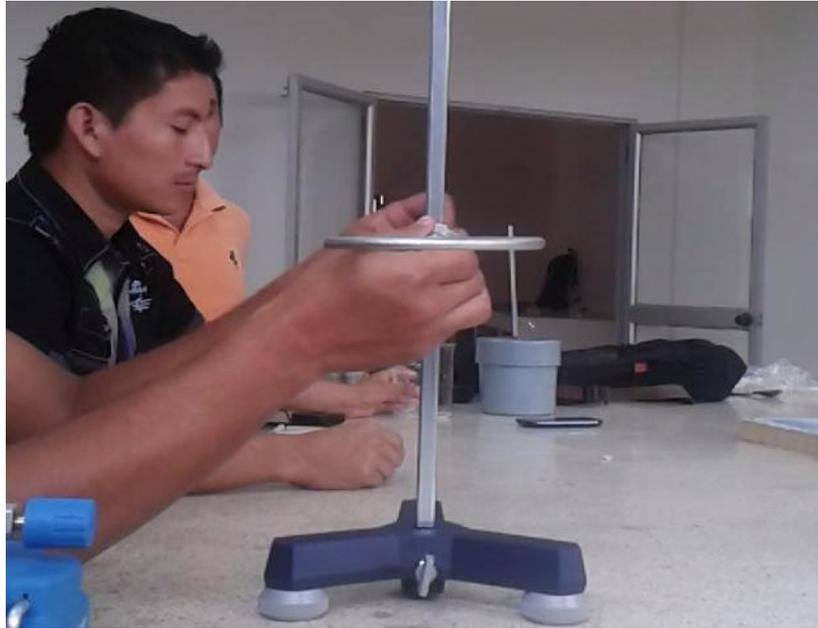
Instalación de equipo para ensayo de calor específico.
