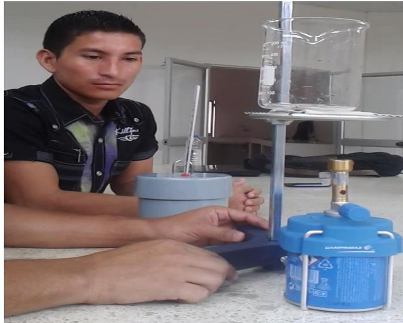
Equipo instalado para ensayo de calor específico.
