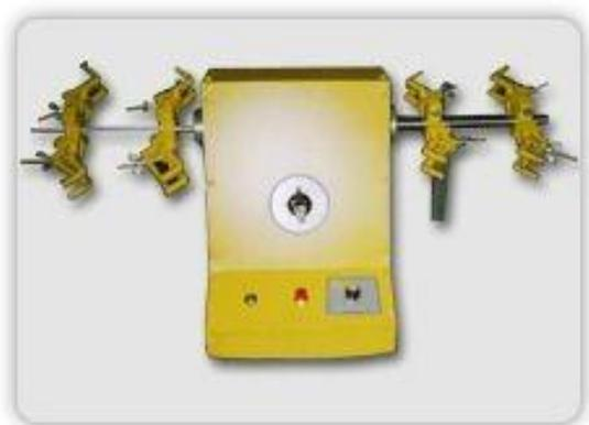
**Ilustración 19:** Agitador tipo Burrel
