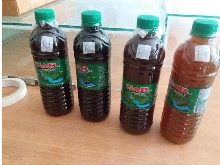
ANEXO 18: MUESTRAS DE LOS REACTORES PARA ANÁLISIS DE DBO<sub>5</sub>
