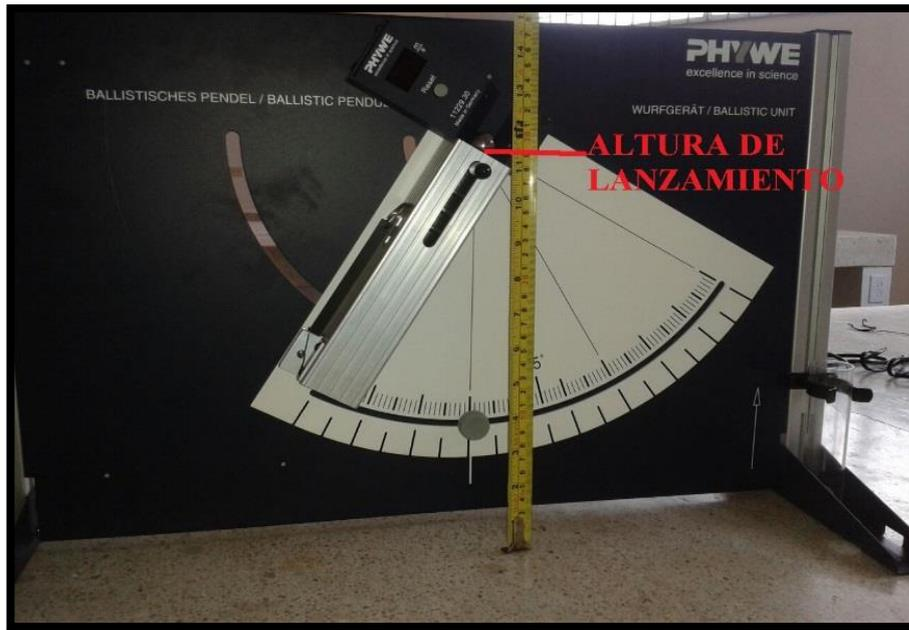
*Inclinación del lanzador y medición de la altura de lanzamiento - Figura (9)*
