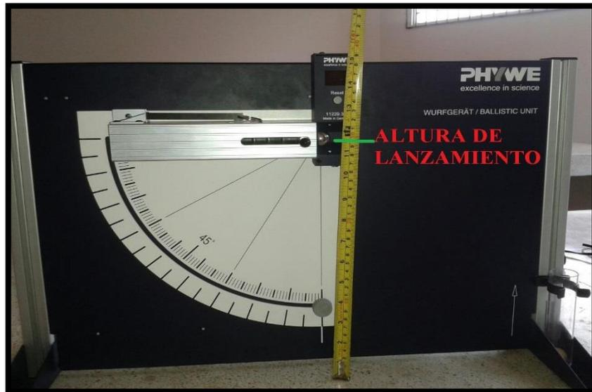
*Medición de la altura de lanzamiento - Figura (7)*
