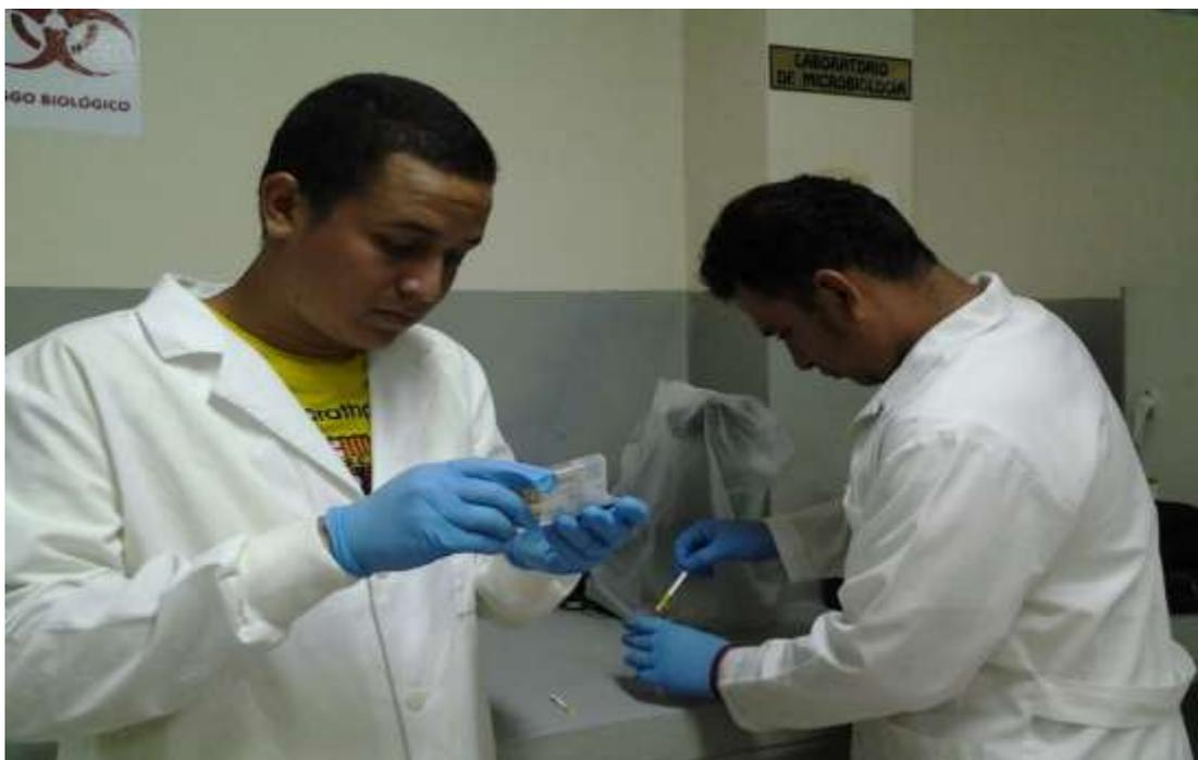
**ANEXO N° 7.-** Medición del pH (mediante el instrumento testo) del agua destilada a utilizarse.
