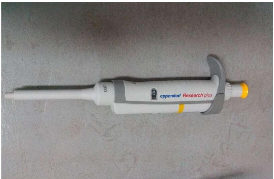
**ANEXO N° 51.-** Micropipetas Eppendorf con las tapas a utilizarse en el bioensayo.
