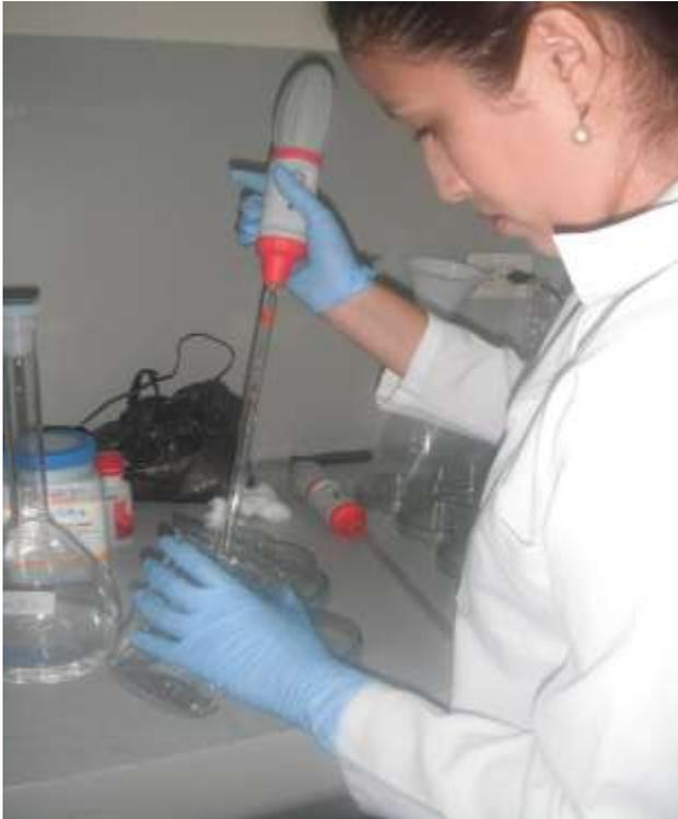
**ANEXO N° 48.-** Llenado de placas con sus respectivas concentraciones de Dicromato de Potasio (9ml de cada concentración en sus respectivas cajas Petri).
