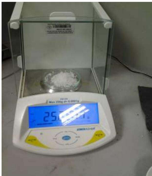
**ANEXO N° 25.-** Pesado de la sal (en grano) que se utilizaría posteriormente para la disolución con agua destilada en la segunda reproducción.
