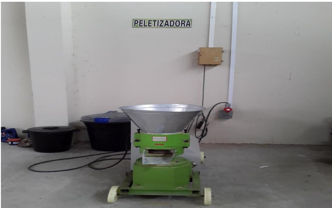
**Imagen 7. Máquina Peletizadora**
